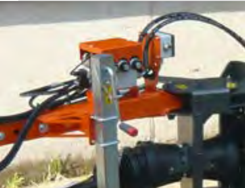
Hydraulikblock zur hydraulischen Verstellung der verschiedenen Arbeitswinkel
