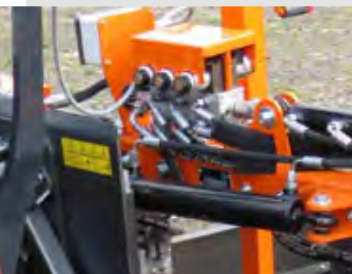
Hydraulikblock zur hydraulischen Verstellung der verschiedenen Arbeitswinkel
