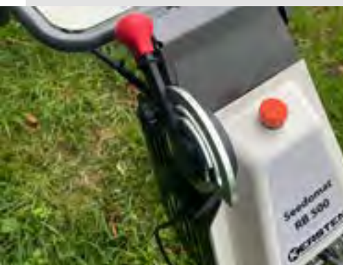
Höhenverstellung Handholm und Saatmengenregler
