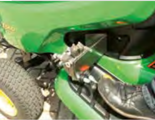
Hydraulische Aushebe- und Schwenkvorrichtung mit Fußpedal für John Deere
