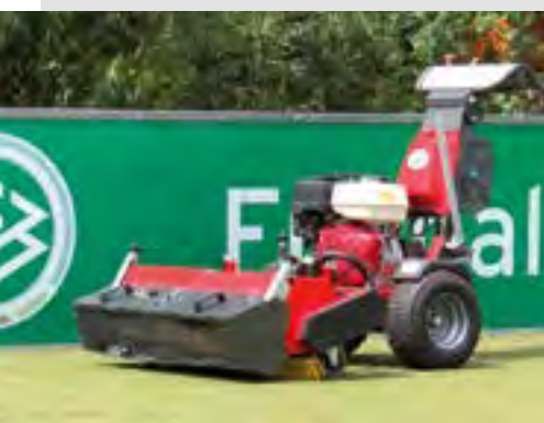
Kunstrasen- Frontkehrmaschine mit starkem Hydromotor
