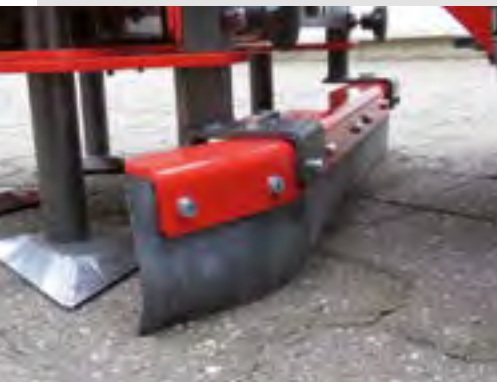
Gummituch zum Egalisieren des gelösten Bodens
