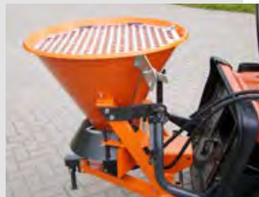
▼ Schleuderstreuer angetrieben über die Leistungshydraulik des Frontkrafthebers
