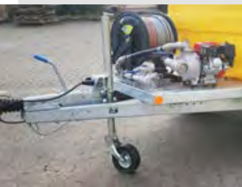
Halb-Automatisch klappendes Stützrad
