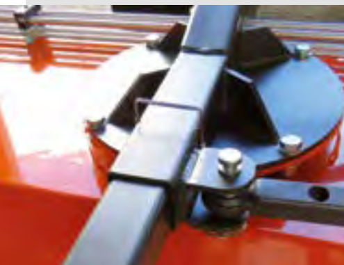
Drehkranz mit mechanischer Seitenverstellung (hydraulisch optional)
