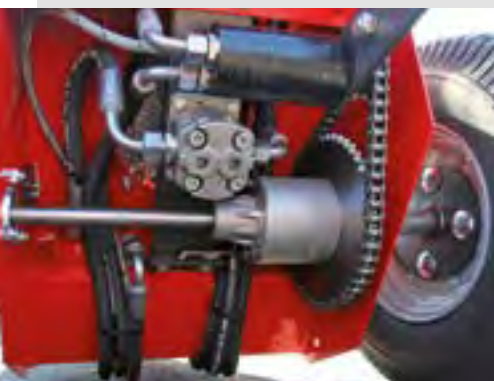
Hydrostatischer, stufenloser Fahrtrieb mit Differentialachse
