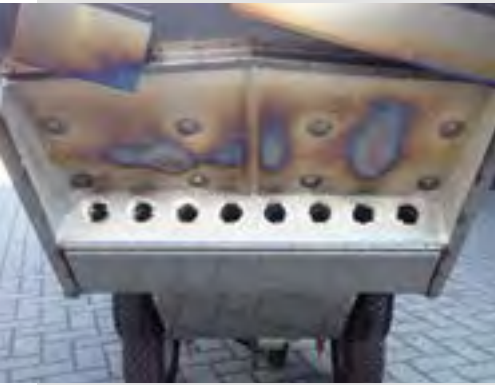
➤ Düsenleiste mit 8 Düsen
