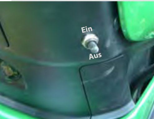
Schalter zum Ausheben des Schneeschildes oder des Mähwerkes
