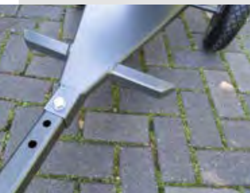
Fußstützen für ergonomisches Sitzen
