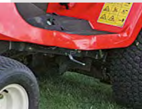
Absperrhahn zur Aushebung von Mähwerk oder Schneeschild
