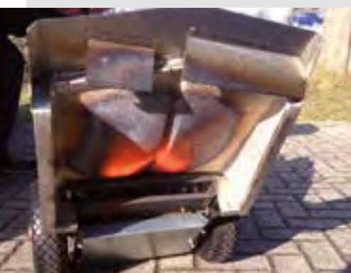
➤ Deflektorplatte für randnahe Arbeiten durch kontrollierte Abführung der heißen Luft
