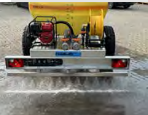
▼ Spritzbalken in Fahrzeugbreite
