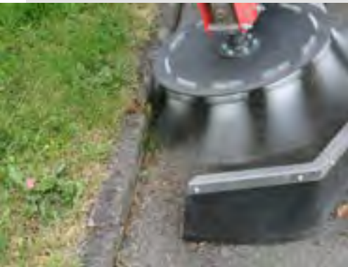
Der Spritzschutz schützt vor Steinschlag
