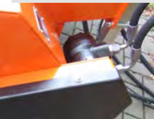
Geschützt positionierter Hydraulikmotor
