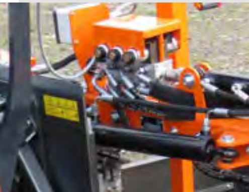
Hydraulikblock zur hydraulischen Verstellung der verschiedenen Arbeitswinkel
