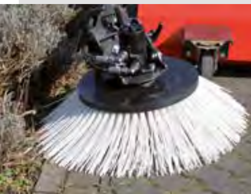
Hydraulischer Seitenbesen mit Anfahrssicherung und werkzeugloser Winkelverstellung
