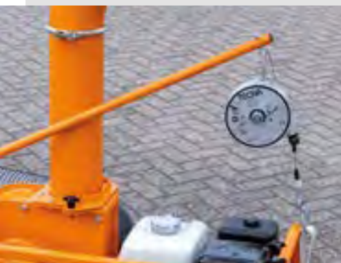
Balancer zur Hebeunterstützung des Schlauchs.
