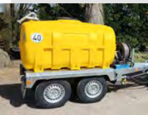
CEMO 2000 Liter PE Fass mit Schwallwänden
