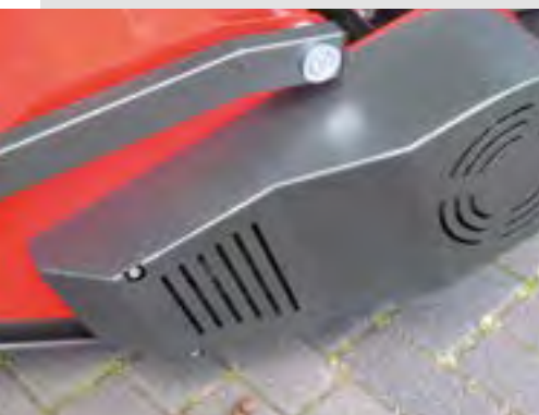
Messerbremse erfüllt EN 12733:2 2019
