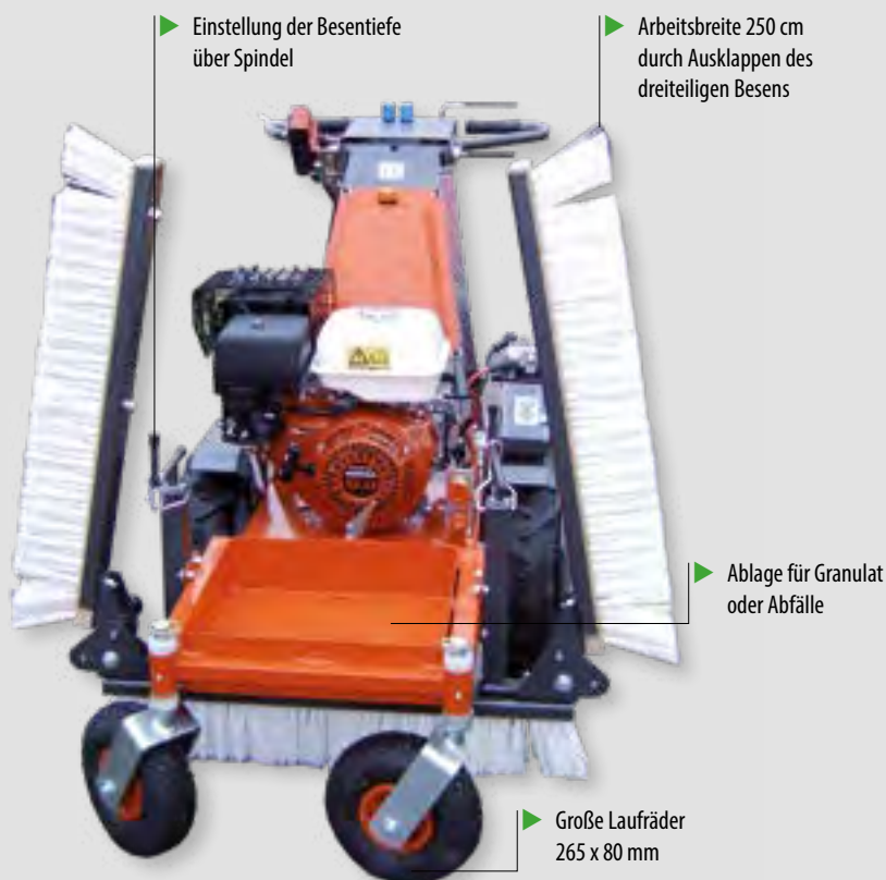
Kunstrasen- Frontkehrmaschine mit starkem Hydromotor
