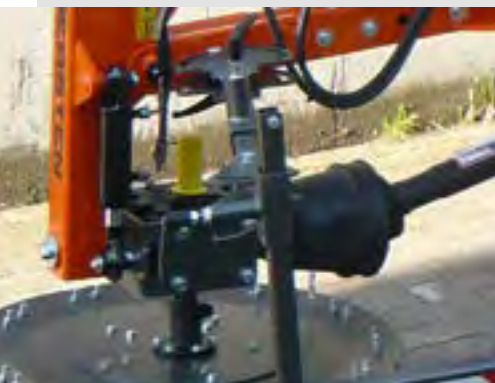
Getriebe drehbar für beide Laufrichtungen
