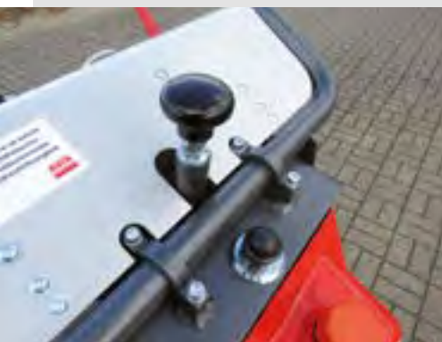
▼ Rastknopf für Seitenverstellung des Handholms links/rechts 30 Grad
