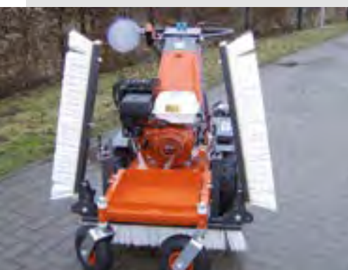
Der Kunstrasenbesen hat eine Arbeitsbreite von insgesamt 250 cm
