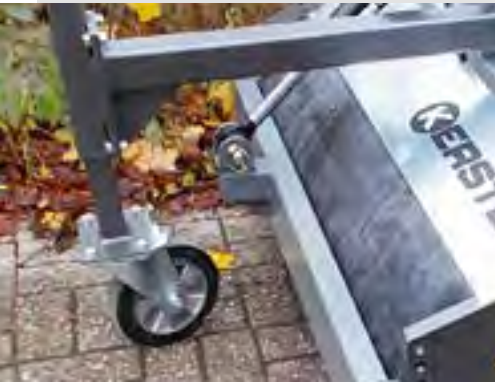
Drittes Laufrad zur besseren Boden Anpassung
