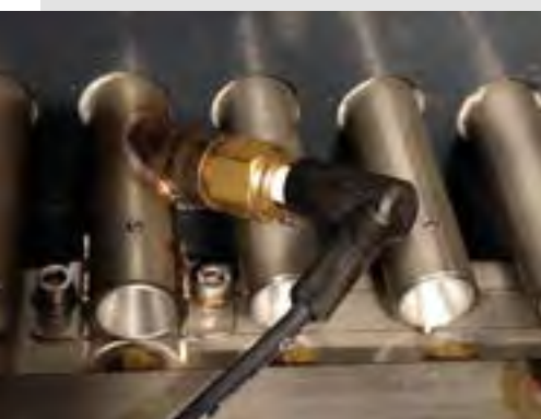
Elektrische Zündung mit Zündüberwachung
