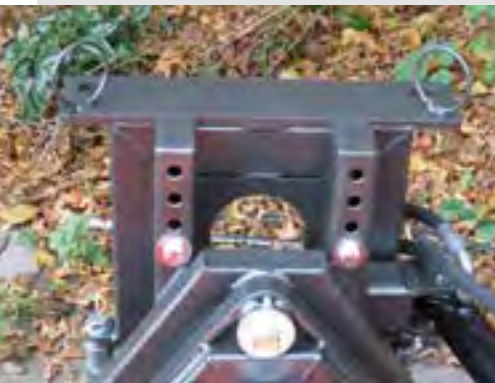
Geschraubter Anbaurahmen mit Lochleiste
