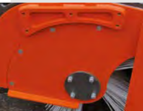
Geteiltes Seitenteil zum einfachen Wechseln der Kehrwalze
