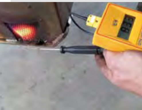
Seitenbrenner Gemessene Temperatur über 800° C
