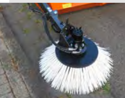
Hydraulischer Seitenbesen mit Anfahrtsicherung und werkzeugloser Winkelverstellung
