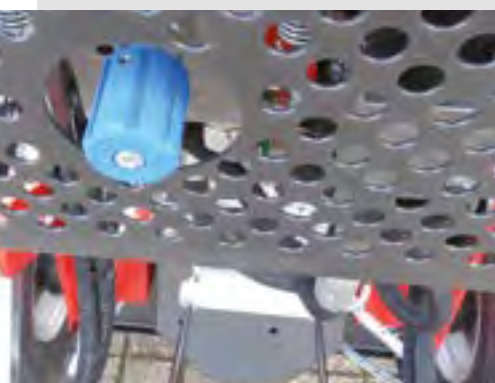
▼ Regelpatrone zum Freischalten des Fahrtriebs
