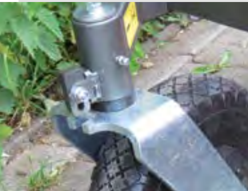
Arretierung der Laufräder (bei Arbeiten an Hanglagen)
