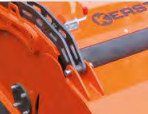
Schwimmend gelagerter Sammelbehälter
