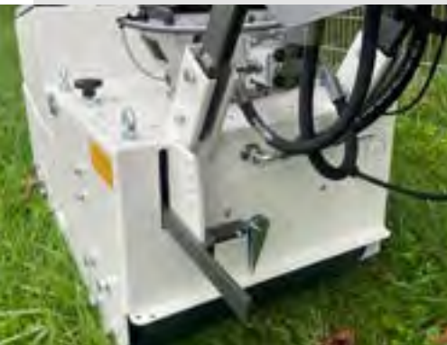
Einstellung Arbeitstiefe Igelwalze
