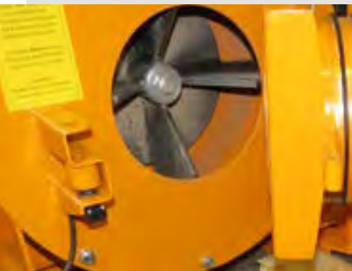
Lüfterrad aus Hardox Stahl
