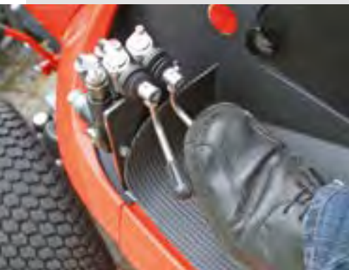
Hydraulische Aushebe- und Schwenkvorrichtung mit Fußpedal für Kubota
