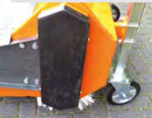
Kettenkasten mit wartungsfreiem Kettenspanner
