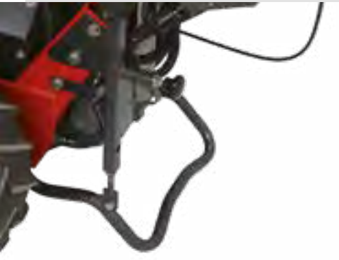
Abstellstütze zum Gerätewechsel
