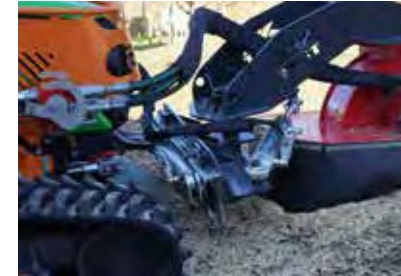
Schnellwechsel-An- bauadapter für funk- gesteuerte Raupen- fahrzeuge
