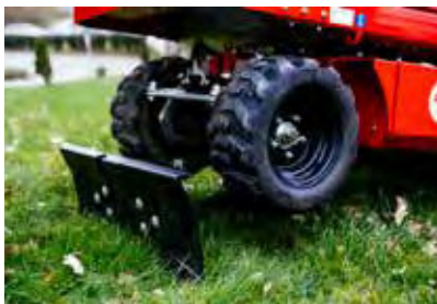
Hydraulisch verstellba- res Planierschild
