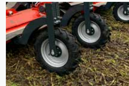
Laufräder Heckan- bau (für Reihenkul- turen)
