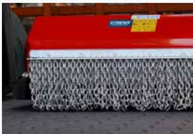
Kettenvorhang (Steinschlag- schutz)
