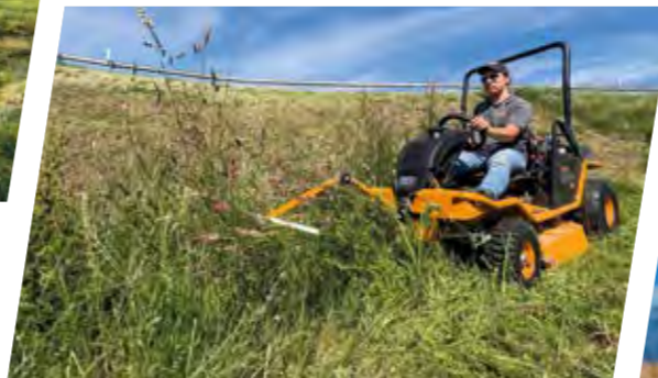
Insektenschonendes Mähen mit Scheuchvorrichtung
