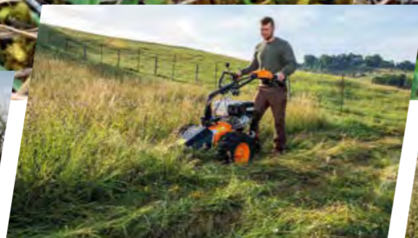
Schonender Schnitt mit Doppelmesser-Mähbalken
