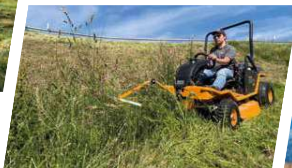
Insektenschonendes Mähen mit Scheuchvorrichtung
