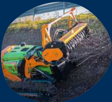
Hubwerk mit max. 970 mm Aushubhöhe
