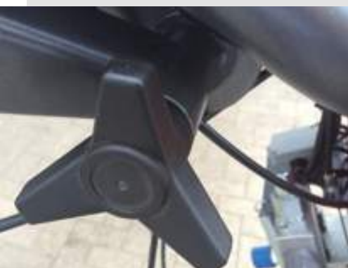
▼ Werkzeuglos höhenverstellbarer Handholm
