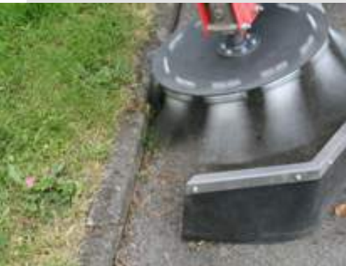
Der Spritzschutz schützt vor Steinschlag
