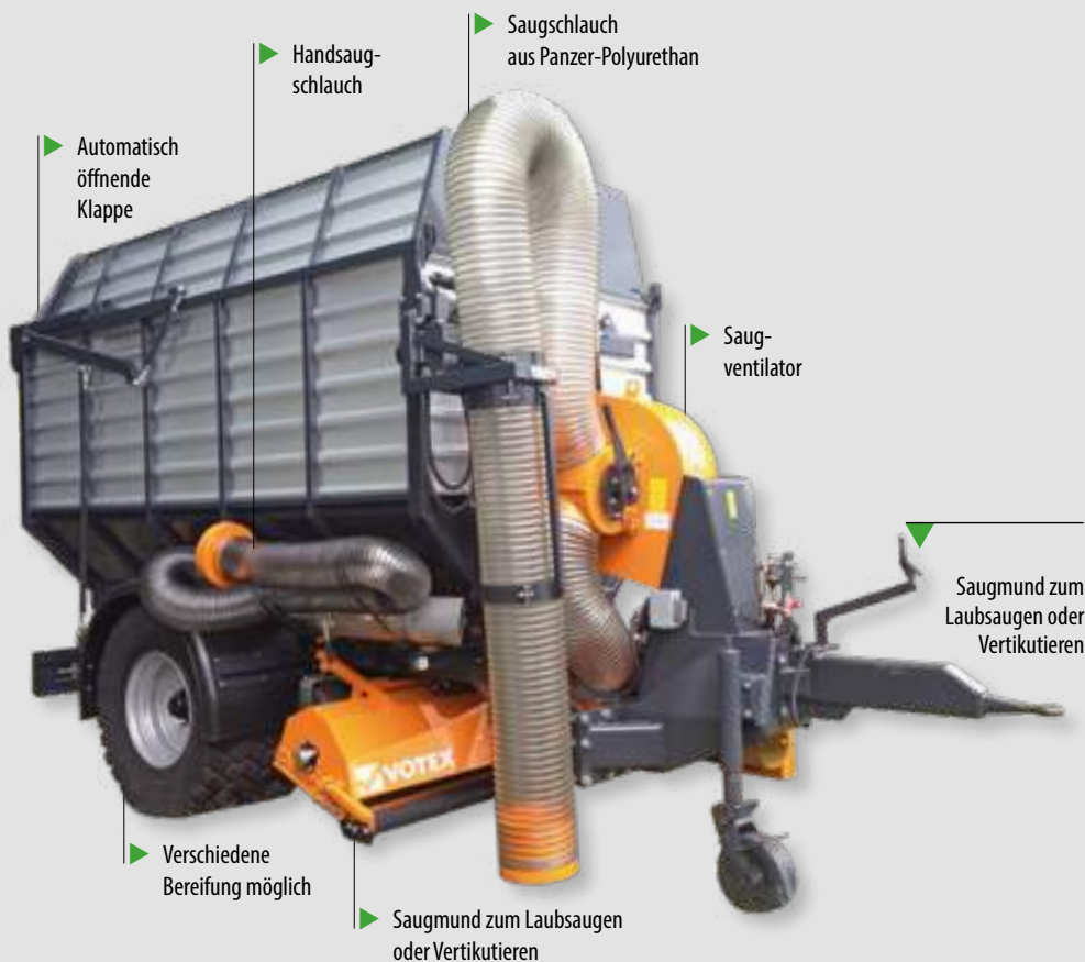
Hydraulische Verstellung Saugmund/ Pendelschlauch
