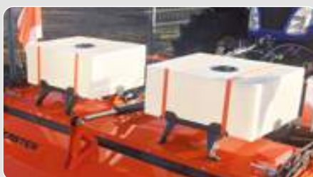
Wassersprengereinrichtung (WAS 200 KM 52)
