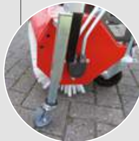
Option: Praktische Abstellstützen für längere Lagerung, um die Kehrwalze nicht zu beschädigen
