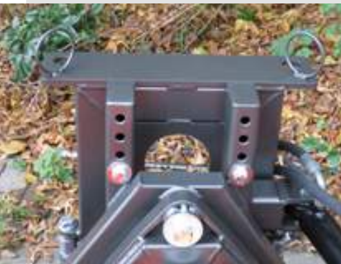
Geschraubter Anbaurahmen mit Lochleiste
