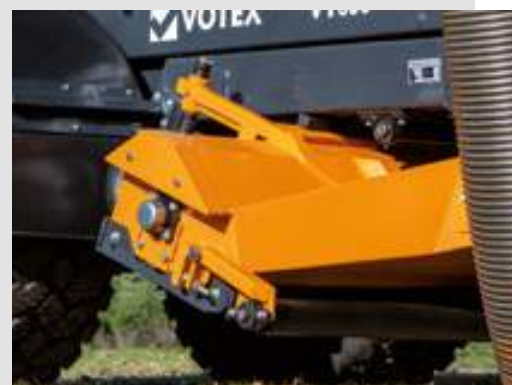
Saugmund zum Laubsaugen oder Vertikutieren
