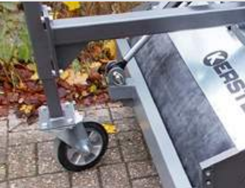
Drittes Laufrad zur besseren Bodenanpassung
