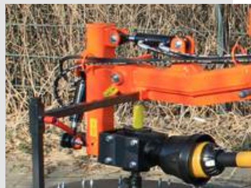
▶ Mechanische oder hydraulische Winkelverstellung
