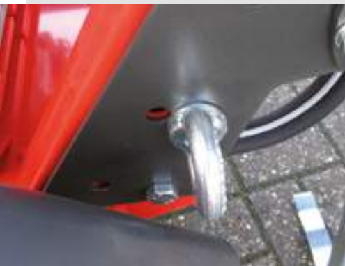
▼ Transport- und Befestigungsösen
