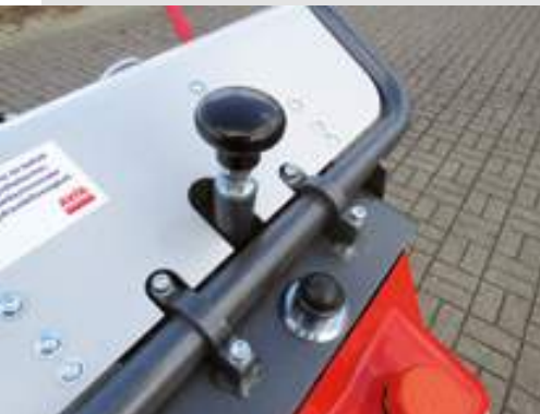
▶ Rastknopf für Seitenverstellung des Handholms links/rechts 30 Grad
