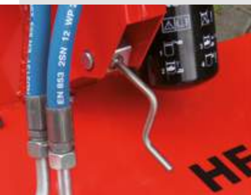
Kurbel zur Verstellung der Arbeitshöhen
