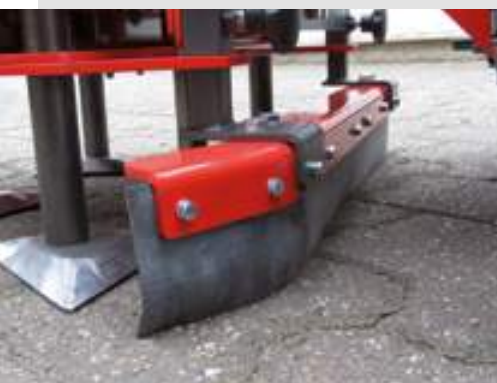
Gummituch zum Egalisieren des gelösten Bodens
