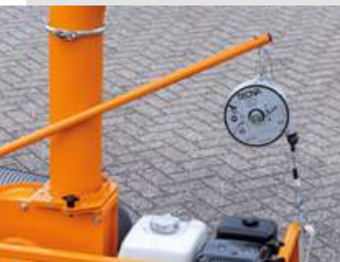
Balancer zur Hebeunterstützung des Schlauchs.
