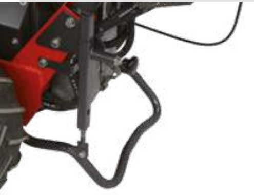
Abstellstütze zum Gerätewechsel
