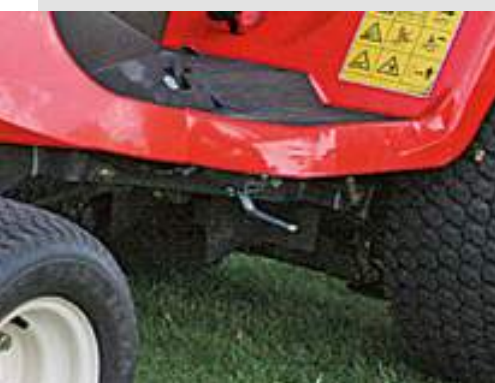
Absperrhahn zur Aushebung von Mähwerk oder Schneeschild
