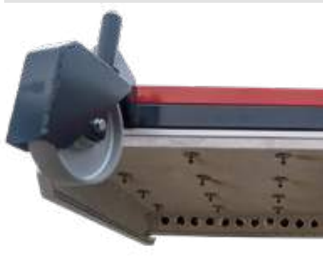
Düsenleiste und Wärmeisolierung
