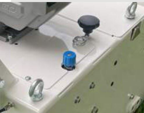
Stufenlose Geschwindigkeitsregelung der Igelwalze
