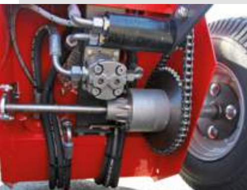
Hydrostatischer, stufenloser Fahrtrieb mit Differentialachse
