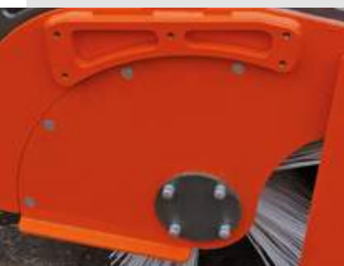
Geteiltes Seitenteil zum einfachen Wechseln der Kehrwalze
