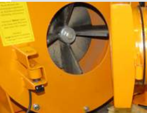
Lüfterrad aus Hardox Stahl
