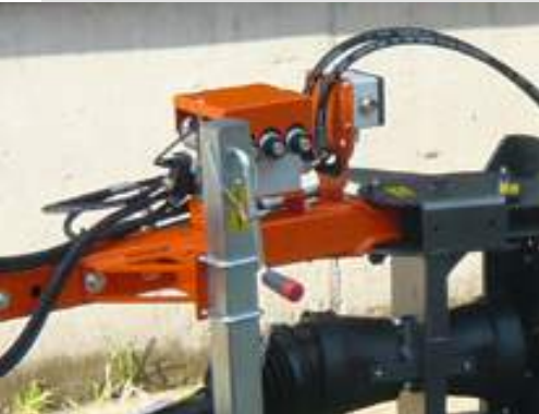
Hydraulikblock zur hydraulischen Verstellung der verschiedenen Arbeitswinkel
