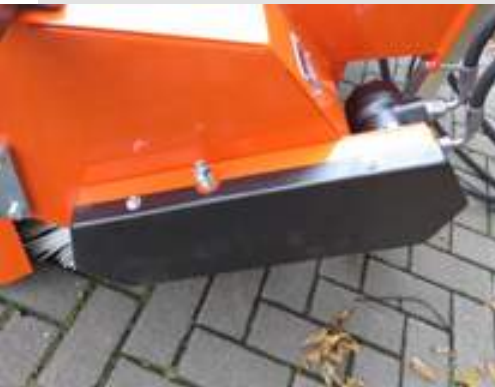
Kettenkasten mit wartungsfreiem Kettenspanner
