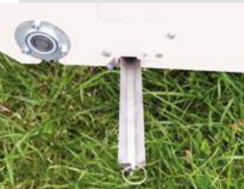
Saatgutrinne zum Einstellen der Saatgutmenge
