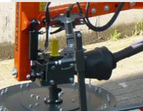
Getriebe drehbar für beide Laufrichtungen
