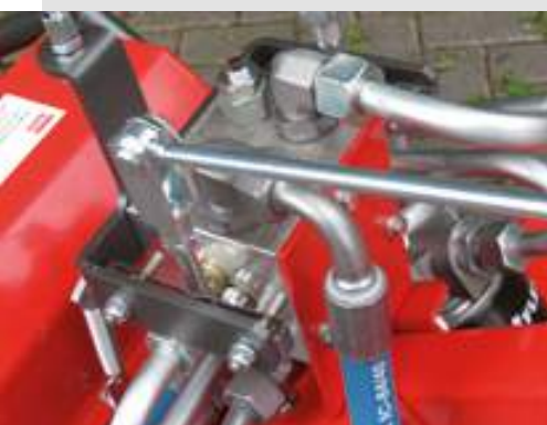
Hydraulikventil für alle Funktionen
