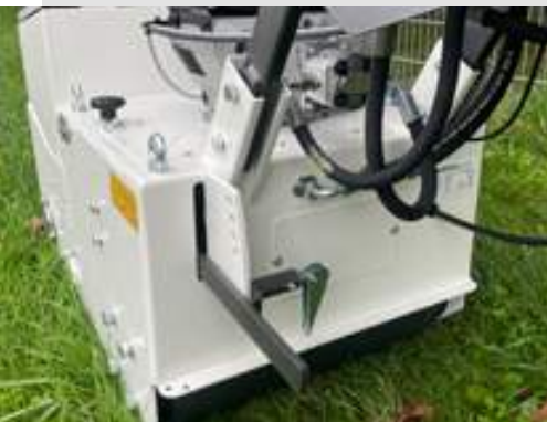
Einstellung Arbeitstiefe Igelwalze
