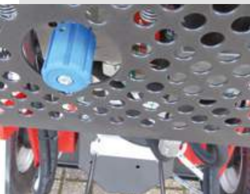
▶ Regelpatrone zum Freischalten des Fahrantriebs
