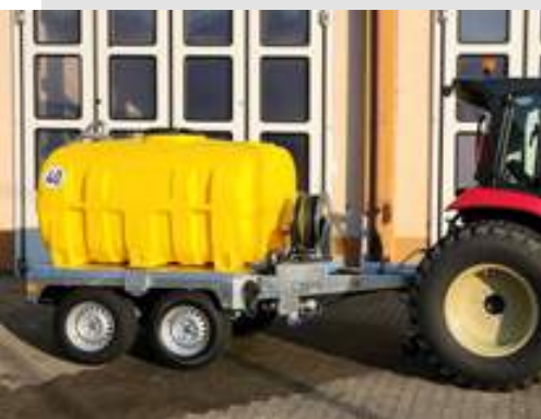
CEMO 2000 Liter PE Fass mit Schwallwänden
