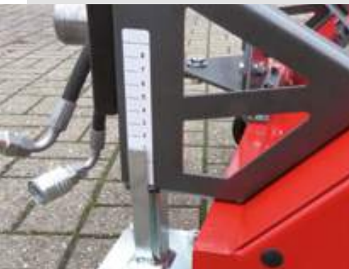
Stufenlose Höhenverstellung der Kehrwalze
