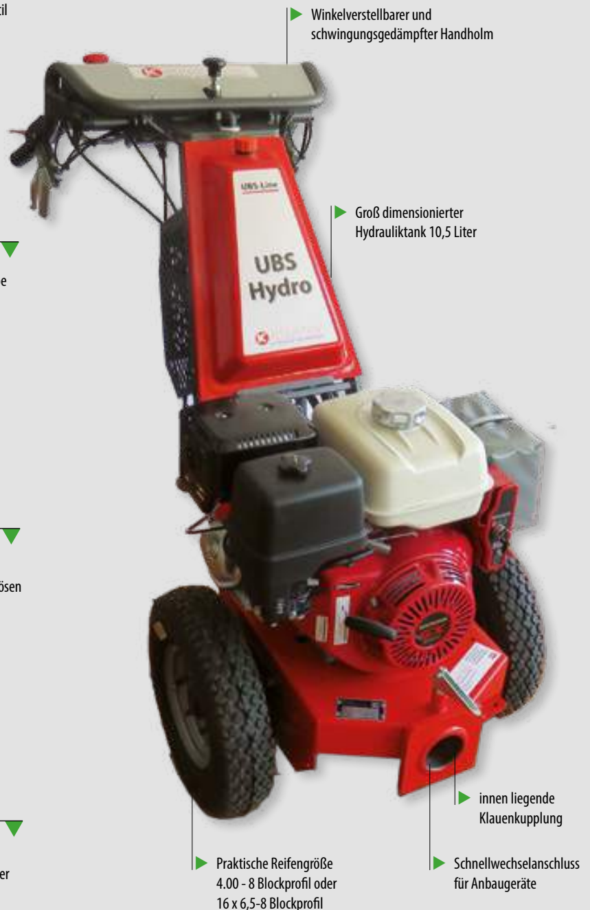
▼ Lenkung über 2 Radmotoren Proportionalventil
