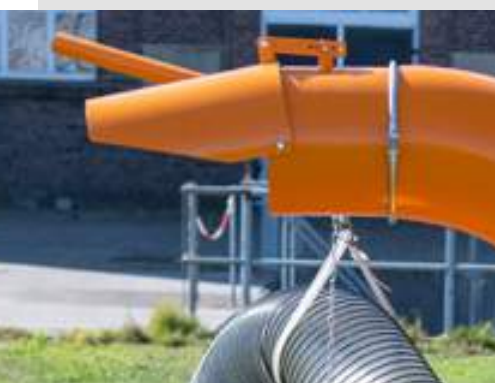
Verstellbare Auswurfklappe zur Wurfweitenregulierung
