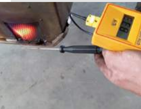
Seitenbrenner Gemessene Temperatur über 800° C
