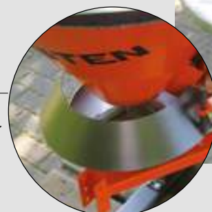
Streuweitenbegrenzer von 0,5-4 Meter einstellbar
