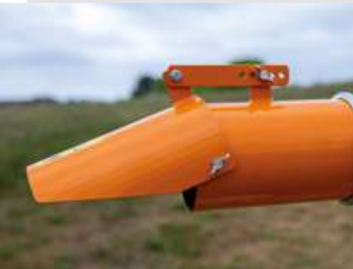
Verstellbare Auswurfklappe zur Regulierung der Wurfweite.
