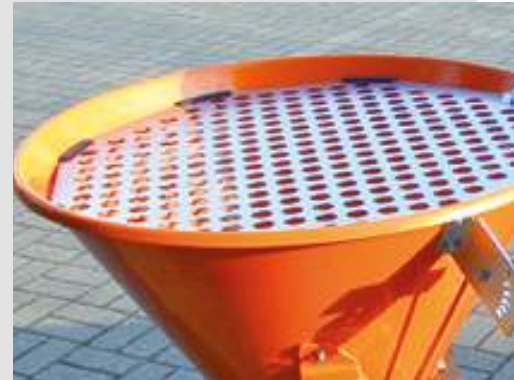
Klumpengitter/Ablage für Zusatzstreugut
