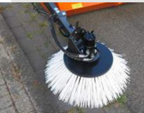
Hydraulischer Seitenbesen mit Anfahrtsicherung und werkzeugloser Winkelverstellung
