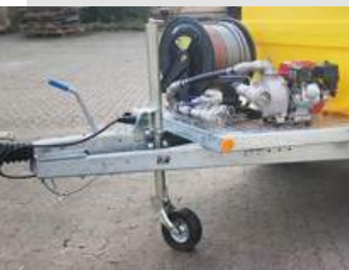
Halb-Automatisch klappendes Stützrad
