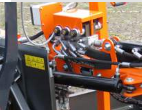
Hydraulikblock zur hydraulischen Verstellung der verschiedenen Arbeitswinkel
