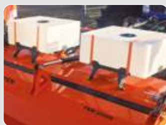
Wassersprengereinrichtung (WAS 200 KM 60)
