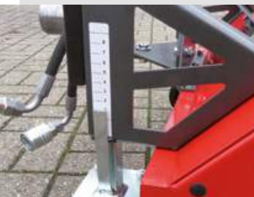
Stufenlose Höhenverstellung der Kehrwalze
