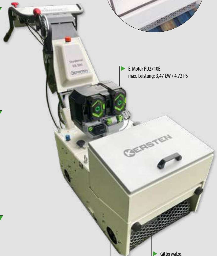
innenliegender Antriebsmotor (Allwalzenantrieb)
