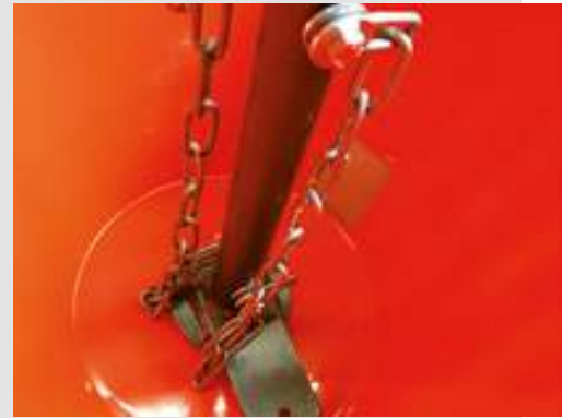
Rührfinger zur Verteilung des Streuguts
