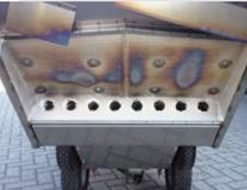
➤ Düsenleiste mit 8 Düsen
