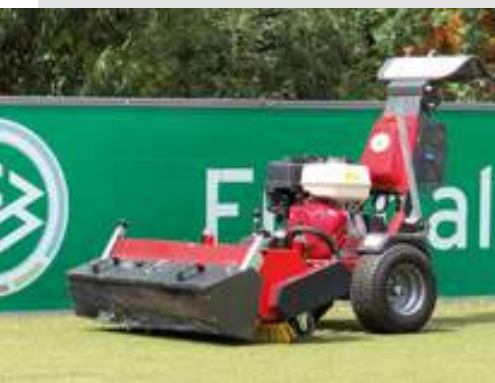
Kunstrasen- Frontkehrmaschine mit starkem Hydromotor
