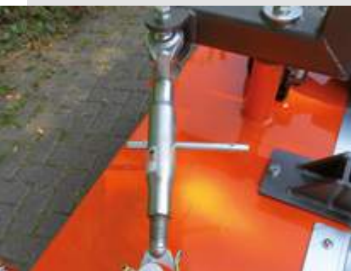
Mechanische stufenlose Seitenverstellung (hydraulisch optional)
