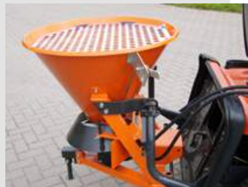
▼ Schleuderstreuer angetrieben über die Leistungshydraulik des Frontkrafthebers
