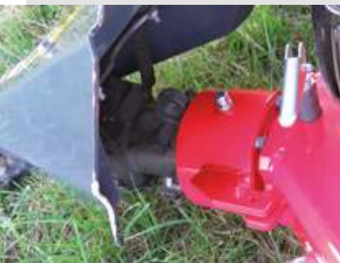
Untersetzungsgetriebe für besondere Laufruhe
