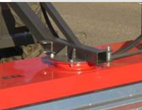
Drehkranz zur Seitenverschwenkung (hydraulische Verstellung optional)
