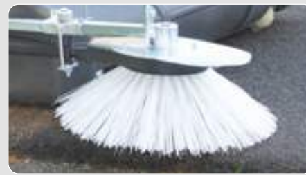
Anbau-Seitenbesen, hydraulisch angetrieben
