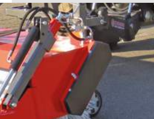
Innenliegender Hydraulikmotor und Kettenkasten
