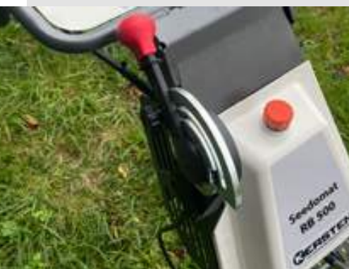
Höhenverstellung Handholm und Saatmengenregler
