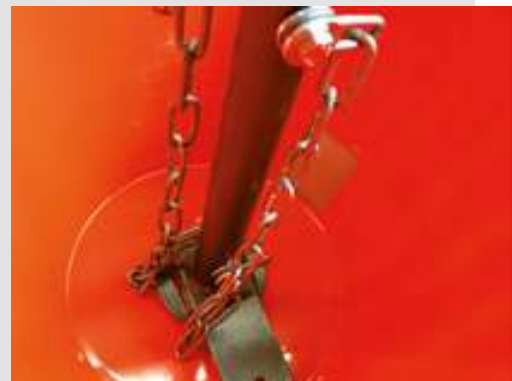
▼ Rührfinger zur Verteilung des Streuguts
