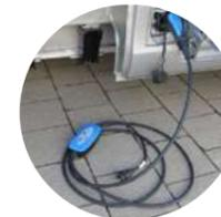
Ihr ARI Elektrofahrzeug können Sie einfach an einer üblichen Außensteckdose mit 230 V aufladen. Ohne Wallbox oder Ladestation. Ein 2,5 m langes Ladekabel ist inklusive. Auch Schnell-Ladekabel (nur bei LiFePO4-Akku), Typ-2-Wallboxadapter sowie komplette Wallboxen sind bei uns erhältlich. ▶ Siehe [ari-motors.com/faq-laden](https://ari-motors.com/faq-laden)
