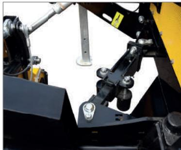
Eine integrierte mechanische Anfahrssicherung löst zuverlässig aus und kehrt selbstständig in Arbeitsposition zurück.
