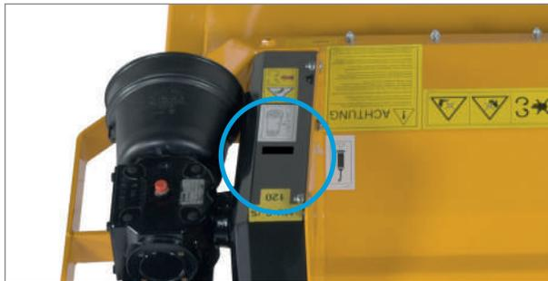
Keilriemenspannung immer im Blick: Keilriemenschutz mit Kontrollöffnung.
