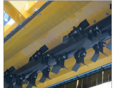
Durch die am Rotor montierten speziellen Y-Messer bei einer variabel verstellbaren Arbeitshöhe bis ca. 11 cm entsteht eine geringere Sogwirkung, wodurch Reptilien und Kleintierlebewesen am Boden verbleiben und nicht mit den Y-Messern in Kontakt kommen.
