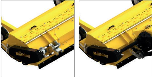
Fahrzeufoptimierter Antrieb sowohl mechanisch als auch hydraulisch möglich.
