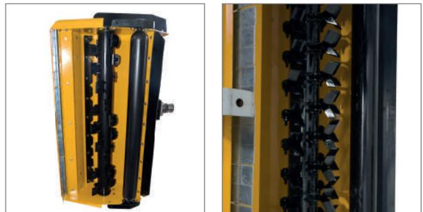
Robuste, schraubbare M-Hartmetall Schälmesser und die durchgängige, nachlaufende Stützwalze perfektionieren das Mähergebnis. Laufruhige 2-fach Y-Messer sind optional verfügbar.
