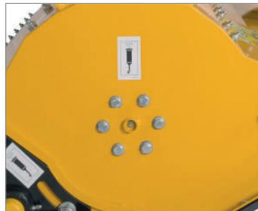
Innenliegendes Rotorlager zum Schutz vor Fremdkörpern und Kollisionen. Ein „Wickeln“ von langfaserigem Material wird durch den gesonderten Wickelschutz vermieden.
