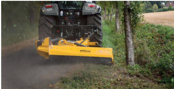
Ein großzügiger Verschieberegion ermöglicht das Arbeiten sowohl hinter als auch neben dem Traktor. Enge Zufahrten und Seitenstreifen können gleichermaßen gemulcht werden.
