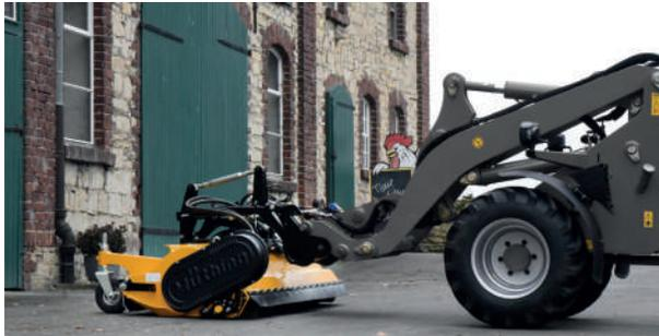
Fahrzeugspezifische Anbauteile: Der niedrige Koppelpunkt sorgt für eine gute Übersicht durch die tiefe Schwingenposition. Gute Zugänglichkeit für die hydraulischen Verbindungen.
