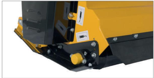
Fein abgestuft verstellbare Stützwalze zur Tiefenführung.
