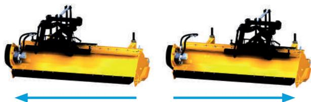
Hydraulische Seitenverschiebung mit 26 cm Verschiebeweg. Versetztes Mulchen neben dem Fahrzeug schafft Flexibilität bei Bäumen, Einfahrten oder anderen Hindernissen (optional). Die mechanische Seitenverschiebung ist serienmäßig.
