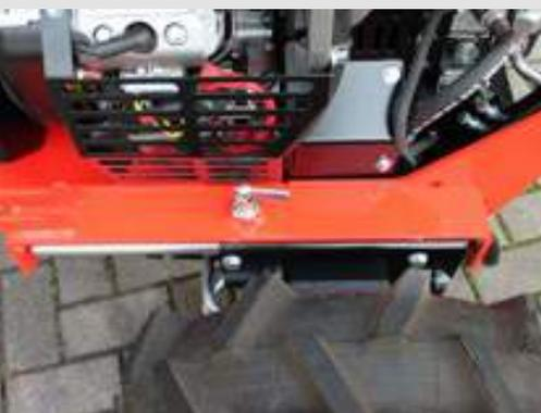
mechanische/hydraulische Achsverschiebung, um die Einheit auszubalancieren
