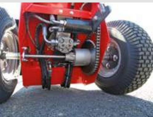
Hydrostatischer, Stufenloser Fahrtrieb mit Differenzialachse
