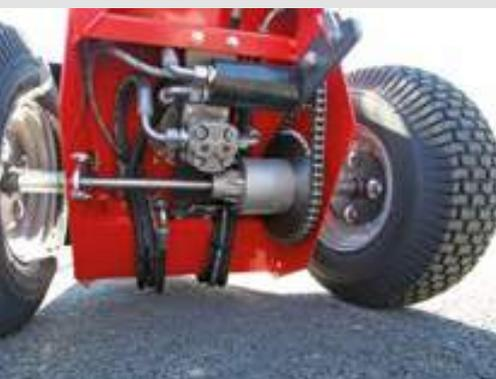
Hydrostatischer Fahrtrieb mit Differenzialachse
