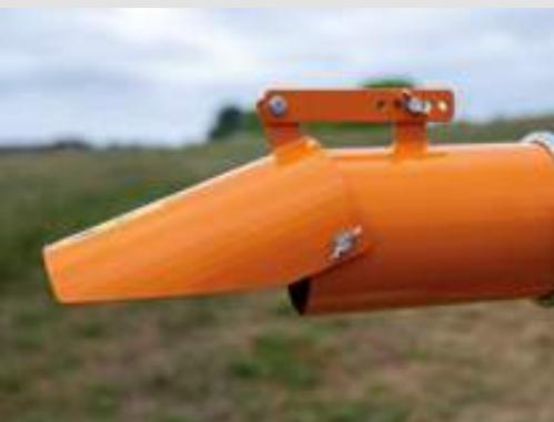
Verstellbare Auswurfklappe zur Regulierung der Wurfweite.
