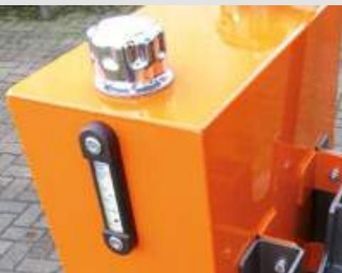
Ölnachfüllstutzen und Öltemperaturanzeige
