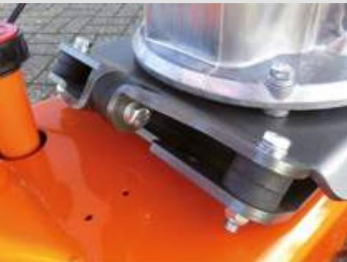
Vibrationsgedämpfter Motor für ermüdungsfreies Arbeiten.
