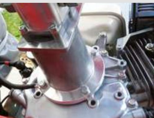
Wartungsfreie Zahnradpumpe mit Direktantrieb
