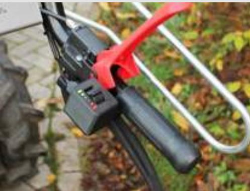
elektrisch angesteuerte Lenkhebel mit variabler Zero Turn-Funktion
