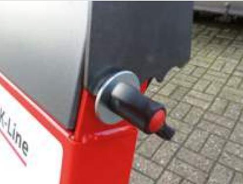
Dreifach werkzeugloser, in Höhe verstellbarer Handholm
