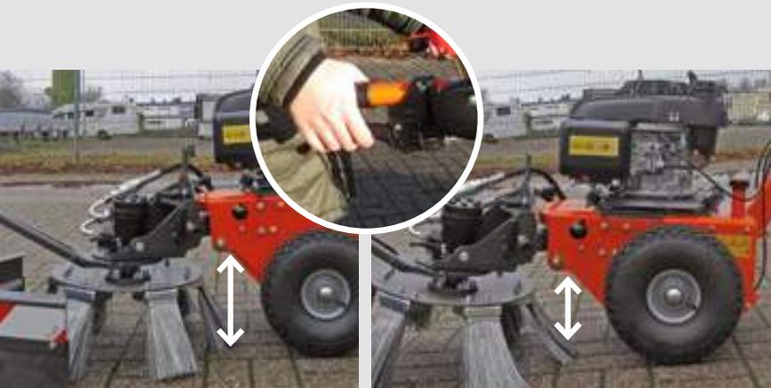
Stufenlose höhenverstellbare Achse, um Werkzeugverschleiß auszugleichen.
