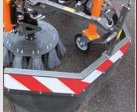
Mechanische oder hydraulische Winkelverstellung
