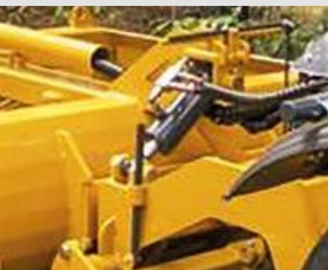
Seitenverstellung für Dachprofil
