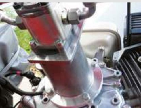
Wartungsfreie Zahnradpumpe mit Direktantrieb
