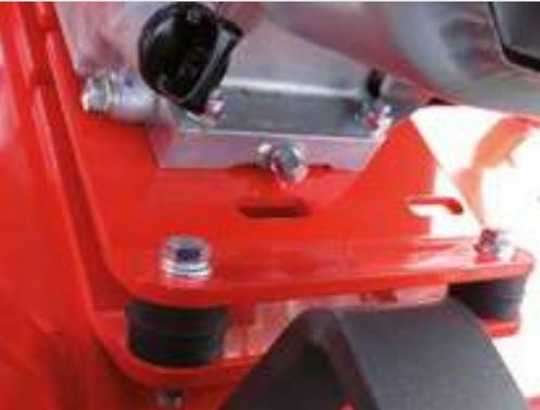
Vibrationsgedämpfter Motor für ermüdungsfreies Arbeiten.
