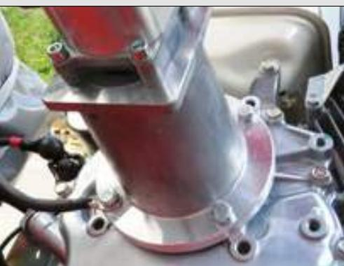
Wartungsfreie Zahnradpumpe mit Direktantrieb
