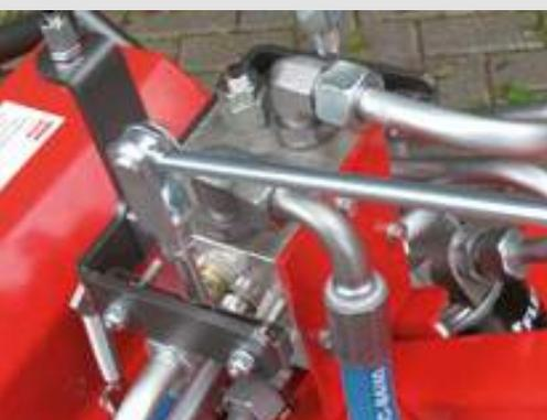
Hydraulikventil für alle Funktionen
