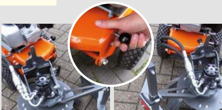
Bürstenteller in Fahrrichtung rechts oder links schwenkbar. Drehrichtung des Bürstentellers wahlweise links oder rechts, durch einfaches Umstecken der Hydraulikanschlüsse.
