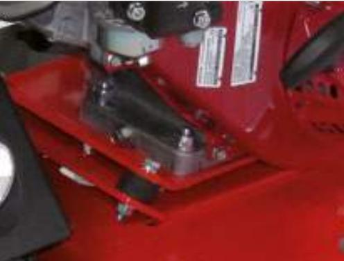
Vibrationsgedämpfter Motor für ermüdungsfreies Arbeiten.
