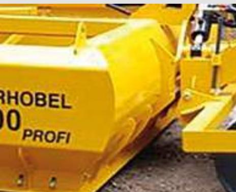
Gerundete Rückwand für optimalen Gleitfluss ohne Entmischung
