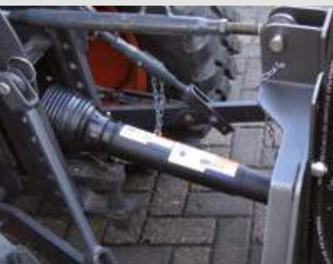
Für 540 rpm Zapfwellengeschwindigkeit ausgelegt, auf Anfrage andere Geschwindigkeiten möglich
