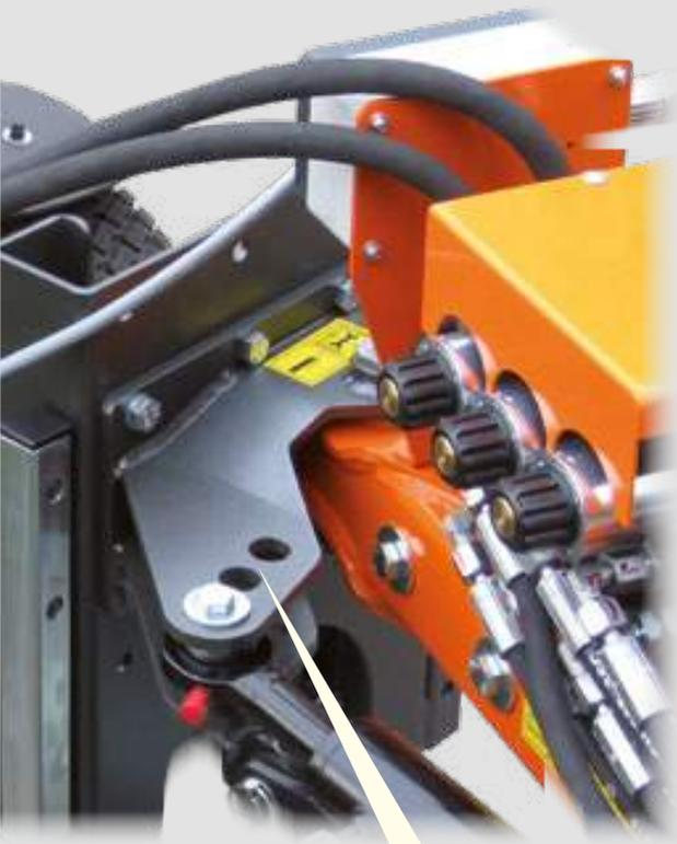
Drei Einstellmöglichkeiten für Schwenkbereich
