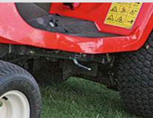
Absperrhahn zur Aushebung von Mähwerk oder Schneeschild
