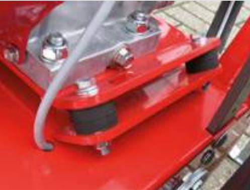
Vibrationsgedämpfter Motor für ermüdungsfreies Arbeiten.
