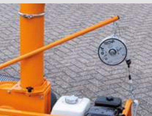
Balancer zur Hebeunterstützung des Schlauchs.
