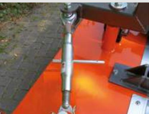
Mechanische stufenlose Seitenverstellung
