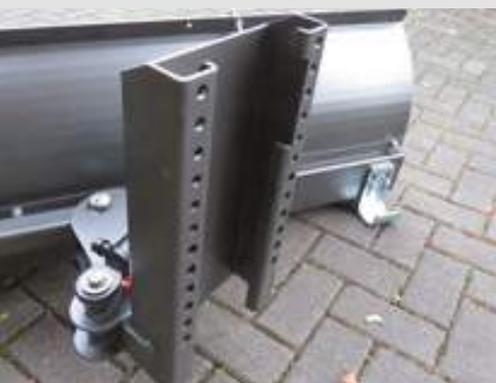
Anbauflansch mit Lochschiene zur optimalen Anpassung an das Trägerfahrzeug
