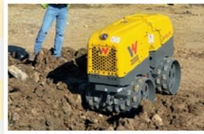
Entwicklung der ersten Infrarot-Fernsteuerung für Grabenwalze und Vibrationsplatte
