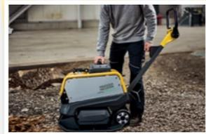
Einführung erster reversierbarer Akkuplatte mit Direktantrieb
