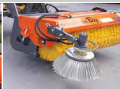
Seitenkehrbesen mit Federelement (50% PP / 50% Stahl)
