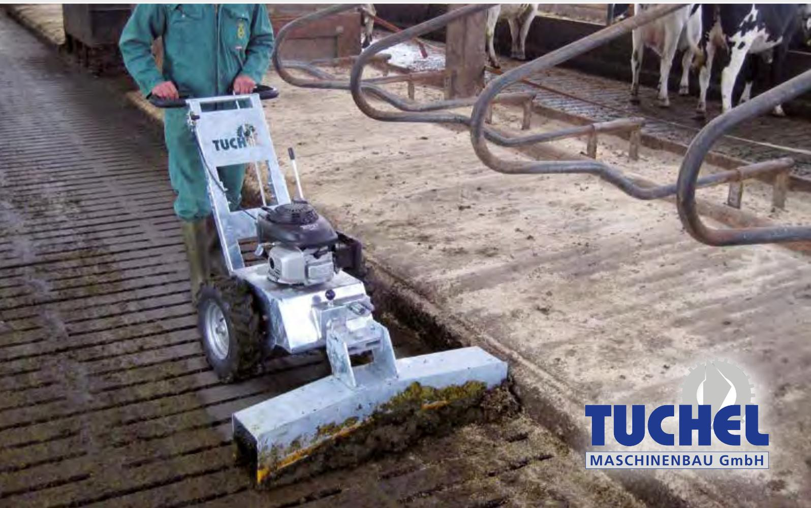
Eine stabile Gestängesteuerung und die großen Ackerstollenräder sorgen dafür, dass das Leistungsvermögen voll ausgeschöpft wird. Serienmäßig ist das Grundgerät mit Hydraulikantrieb und Hydraulikanschlüssen für weitere Anbaugeräte ausgerüstet. Diese können werkzeuglos montiert und demontiert werden.
