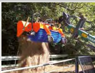
hydraulische Entleerung mit Freikehrmodus
