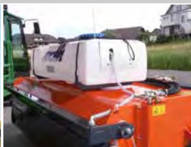
Wassersprüheinrichtung mit 100/200 Liter Wassertank
