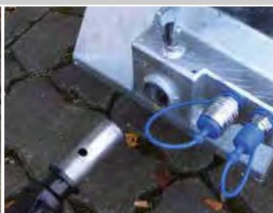
Schnellwechseleinrichtung u. doppelt wirkender Hydraulikanschluss serienmäßig
