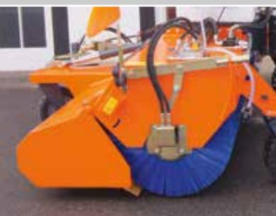
innenliegender Motor und Kehr-Keil-Optimierung
