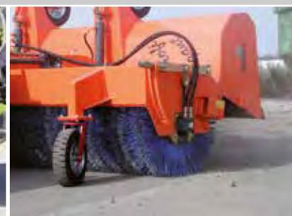
einfache Bürstennachstellung über Rasthebelsystem
