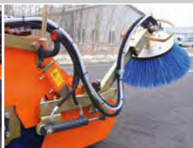
hydraulisch klappbarer Seitenkehrbesen
