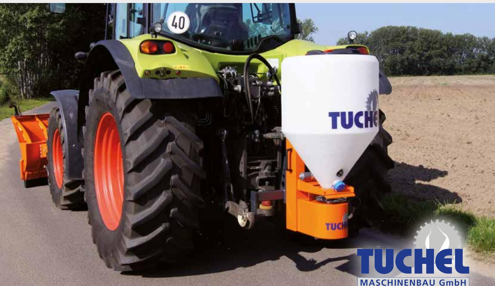
Die beiden Salzstreuer TS 120 und 200 haben einen Vorratsbehälter mit einem Fassungsvermögen von 120 bzw. 200 Litern und sind in wenigen Handgriffen angebaut. Durch einen starken Getriebemotor wird der Streuteller angetrieben, der das Streusalz bis zu 6 m (abhängig vom Streumaterial) auswerfen kann. Die Drehzahl des Streutellers können Sie bequem und einfach in der Fahrerkabine einstellen.
