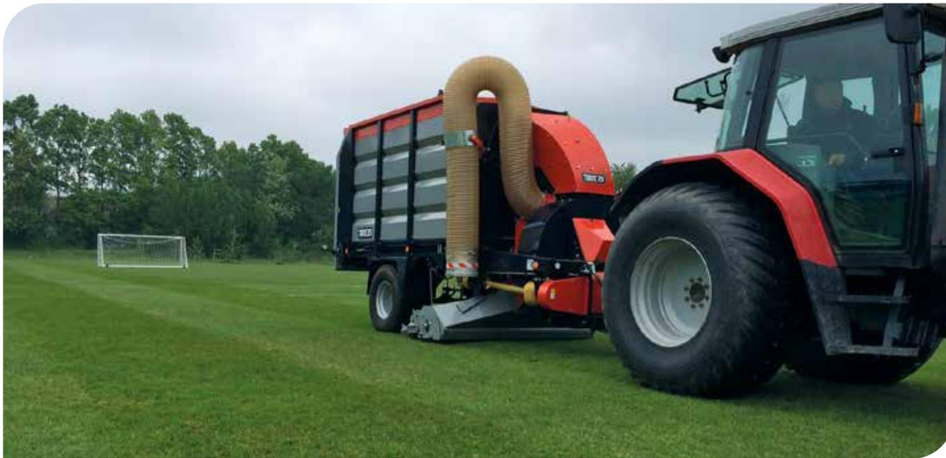
Beispiel einer TRILO Kehrsaugmaschine M10 zum Vertikutieren und Aufsammeln mit einer Arbeitsbreite von 2,1 m. Mit einem Saugschlauch können die Kehrsaugmaschinen der M-Serie auch für andere Arbeiten auf Sportanlagen eingesetzt werden.
