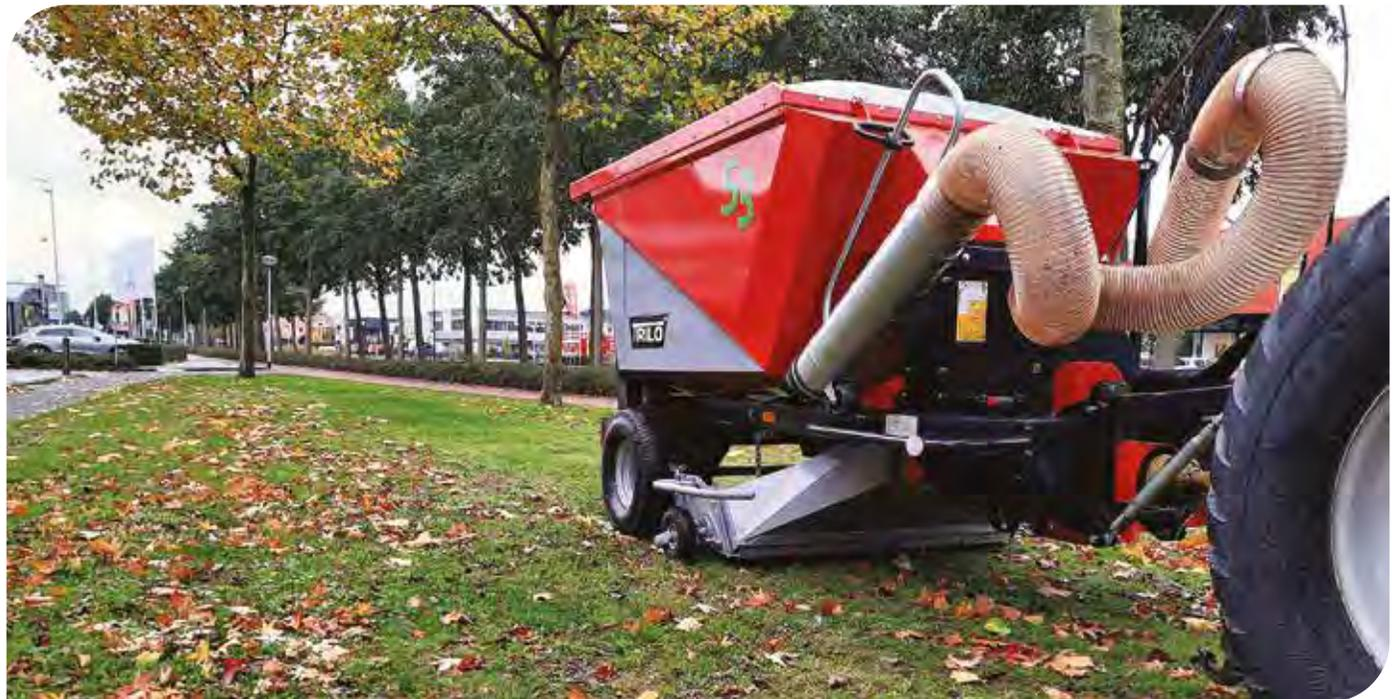
Mit einem TRILO S3 können Sie in einem Durchgang kehren und sammeln. Laubbeseitigung mit einem TRILO Laubsauger ist die effektivste Art der Laubbeseitigung. Die S-Reihe kann optional mit einem handbetätigten Schlauch ausgestattet werden.
