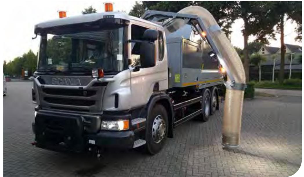
Da der Drehpunkt des Saugschlauchs in der Fahrzeugmitte platziert ist, kann sowohl links als auch rechts im gleichen Abstand vom Fahrzeug gearbeitet werden.
