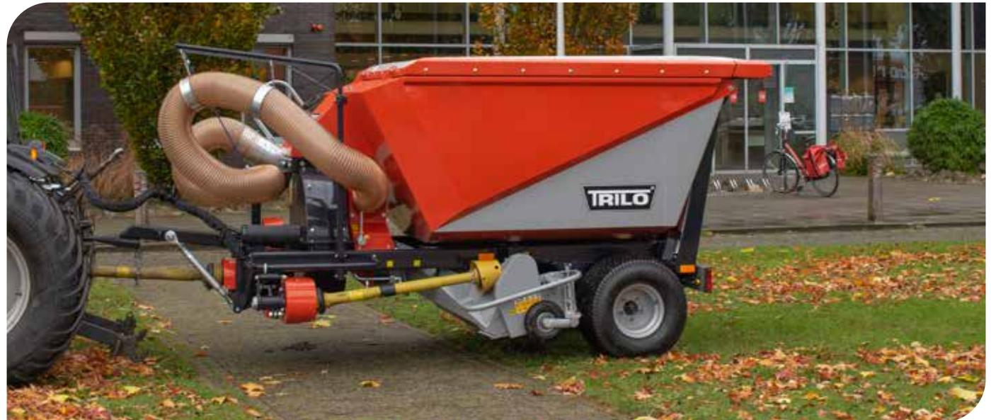
Die kompakten TRILO können nicht nur zum Kehren und Einsammeln verwendet werden, sondern sind mit einer anderen Arbeitsachse auch zum Mähen oder Vertikutieren und Einsammeln in einem Arbeitsgang geeignet.
