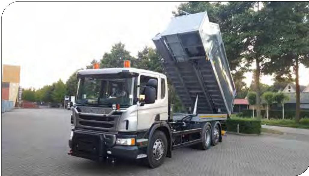
Die Saugcontainer der TH-Serie sind auf einem hydraulisch kippbaren Rahmen montiert.
