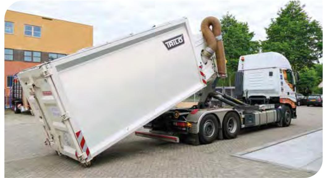
Einfaches Auf- und Abladen mit einem Hakenliftsystem.
