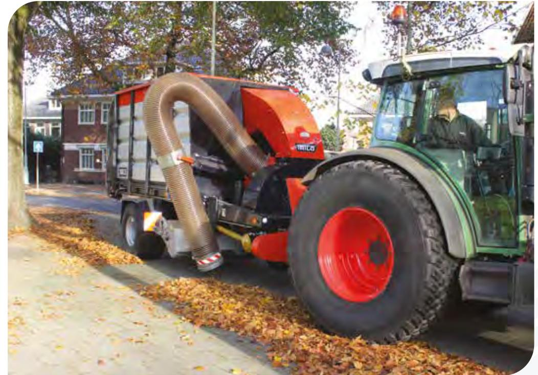
Laub kann nicht nur mit einer in der Saugdüse montierten Bürstenwelle, sondern auch mit einem handbetätigten Schlauch oder mit einem an einem hydraulisch gesteuerten Arbeitsarm montierten Saugschlauch aufgenommen werden.
