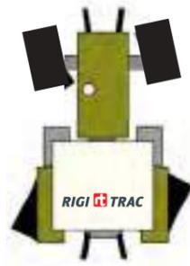
Ab 10° Lenkeinschlag der Vorderachse beginnt automatisch die Lenkfunktion der Hinterachse, bis der Lenkeinschlag vorne und hinten identisch sind
