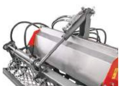
optionale Hydraulische Höhen- und Seitenverstellung der Nachlaufwalze
