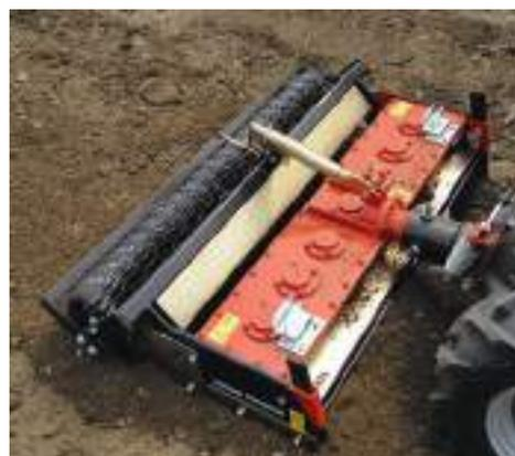
Stufenlose Einstellung der Arbeitstiefe mittels Handspindel
