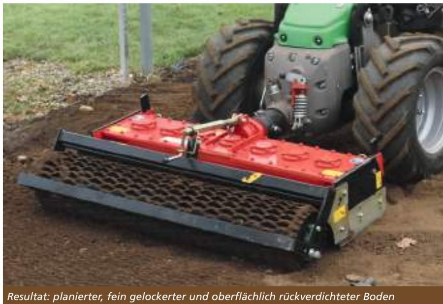
Resultat: planierter, fein gelockter und oberflächlich rückverdichteter Boden
