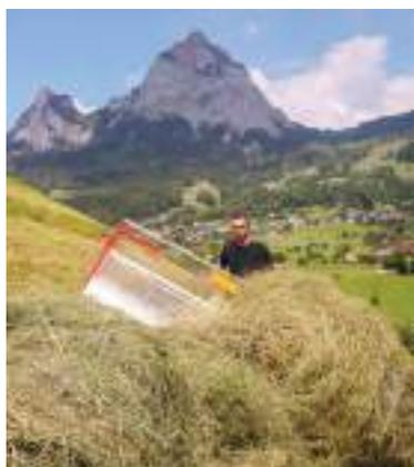
Die Heuschieber-Twister sind für Arbeiten im Steilhang konzipiert und lösen die mühsame Handarbeit mehrerer Personen mit Rechen und Heugabel durch eine Bedienperson am Einachsgeräteträger ab. Aufnehmen und Transportieren von trockenem Erntegut sowie das Befördern in weniger steile Lagen zur Aufnahme mittels Presse oder Ladewagen sind damit einfach möglich. Die Arbeitserleichterung und die Zeitersparnis gegenüber der herkömmlichen Handarbeit sind massiv.
