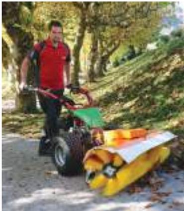
Die leistungsfähigen Rapid Geräte zum Kehren lassen sich flexibel und ganzjährig einsetzen. Im Sommer werden Staub und Schmutz beseitigt, während im Winter frisch verschneite Beläge schwarz gekehrt werden. Es besteht die Möglichkeit in Fahrtrichtung oder seitlich wegzukehren. Wird der Schmutzsammelbehälter montiert, lässt sich im selben Arbeitsgang der Schmutz sauber aufnehmen. Kommt der Seitenbesen zum Einsatz, wird Sauberkeit bis an Hindernisse wie z.B. Randsteine spielend einfach erreicht.
