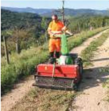
Mit dem Wegepflegegerät werden wassergebundene Flächen, wie z.B. Schotter-, Splitt- und Kieswege/-plätze, einfach, schnell und ökologisch wie ökonomisch sinnvoll gepflegt. Pflanzen werden mittels mechanischer Bewegungen entwurzelt und auf der Oberfläche abgelegt, wo sie einfach entfernt werden können. Dank der variablen Arbeitshöheneinstellung bleibt die Bodenschichtstruktur unbeschädigt. Bearbeitete Flächen erstrahlen so ohne Einsatz von chemischen Stoffen in einem sauberem, gepflegtem Bild.
