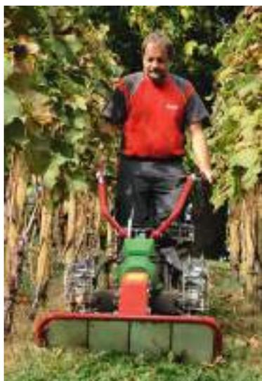
Rapid Ökomulcher eignen sich perfekt zum Mulchen von Gestrüpp und Grünflächen. Die horizontal rotierenden, massiven Stahlmesser haben eine hohe Schnittleistung. Das fein gemulchte Schnittgut wird in der Regel auf dem Boden liegen gelassen. Diese Arbeitsweise ermöglicht eine rasche und saubere Pflege verschiedenster Grünflächen.
