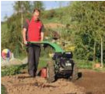
Die Rapid Bodenfräse zerkleinert Erdschollen, fräst Böden fein und lockert diese für den Aufbau. Die genial einfache und robuste Konstruktion besteht durch die Möglichkeit, dass die Fräs-Drehrichtung gegen die Fahrtrichtung gestellt werden kann. Das vereinfacht das Führen der Geräte in harten Böden entscheidend.
