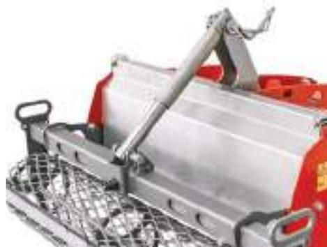
optionale Spindel zur Höhenverstellung der Nachlaufwalze
