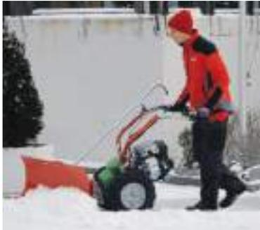
Rapid Räumschilde zeichnen sich durch ihre Vielseitigkeit, Sicherheit und einfache Bedienung aus. Mit dem vom Holm aus bequem bedienbaren Schwenkmechanismus wird Schnee effizient in die gewünschte Richtung weggeschoben. Dank werkzeuglos montierbaren Seitenblechen ist rückstandsloses Räumen von grösseren Flächen möglich.
