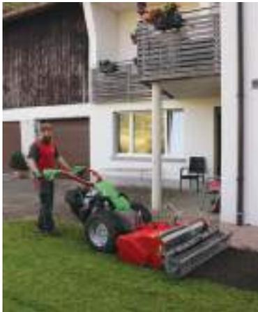
Die Rapid Umkehrfräse arbeitet Altrasen, Pflanzenreste und Steine schon nach nur einem Arbeitsgang nach unten in den Boden ein. Die feine Erde liegt obenauf und der Boden ist wieder bereit für Folgearbeitsschritte. Durch optimale Führung und Anpassung in unebenem Gelände sorgt die Umkehrfräse für ein sauberes Arbeitsbild.
