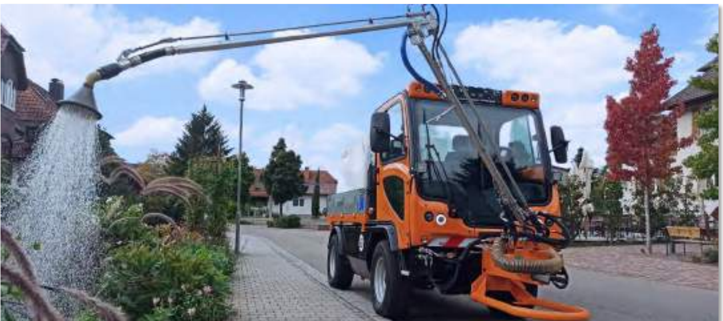
LADOG T1400 mit Gießanlage und 2000L Wasserfass
