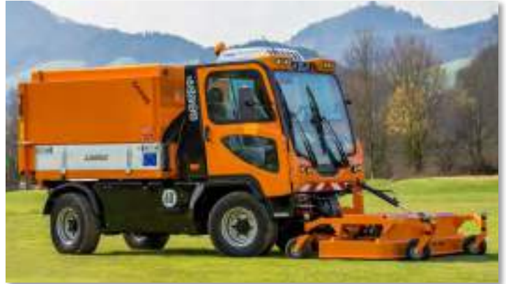
T1400 mit Frontsichelmäher und Saugcontainer
