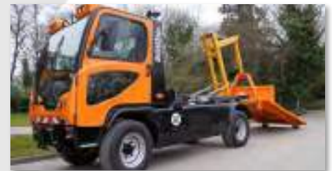
T1400 mit Hakenliftaufbau
