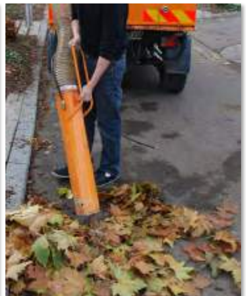
Flexible Absaugung mit optionalem Handsaugrohr
