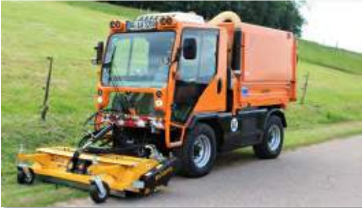
T1250 mit Mittelkanalabsaugung und Schlegelmulcher
