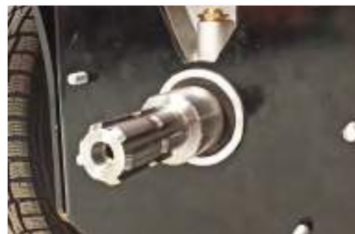
Der Antrieb von diversen Anbaugeräten erfolgt über eine Zapfwelle
