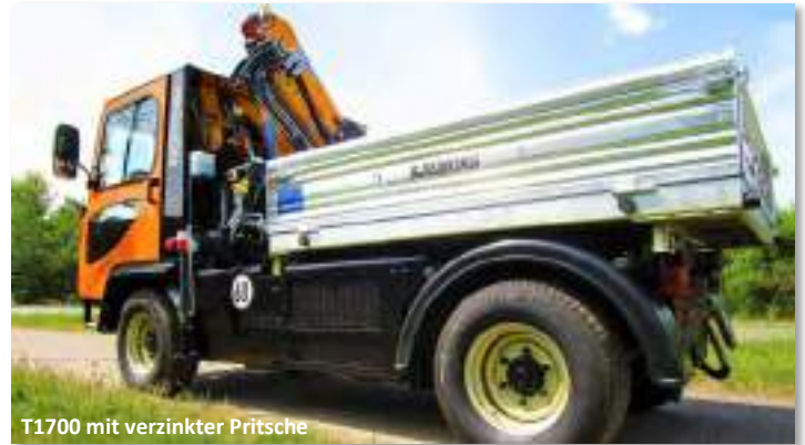
T1700 mit Zwischenachskran und Sonderpritsche
