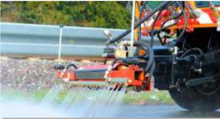
LADOG T1250 mit Düsenschwemmanlage
