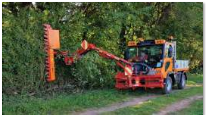
T1700 mit Auslegearm und Heckenschere
