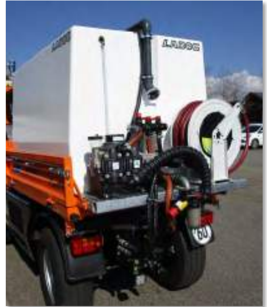
LADOG T1250 mit 2000L Wasserfass und Pumpenaufbau
