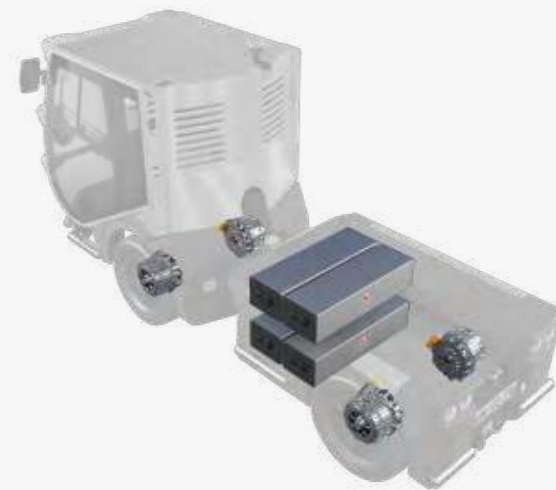
48V-Jungo-Powerpacks und Elektro-Radnabenmotor-Allradantrieb
