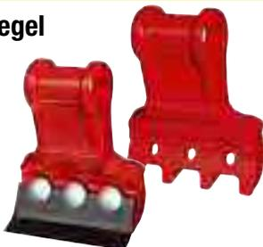
Der Systemshlegel entwickelt aufgrund seiner besonderen Form und dem hohen Eigengewicht von 4,6 kg eine vorteilhafte Saugwirkung und ein besonders schönes Schnittbild. In das Tiefbett des Messerträgers wird wahlweise eine Feinschnittklinge oder eine Krallenklinge eingeschraubt. Die Klingen können kostengünstig ausgewechselt werden.
