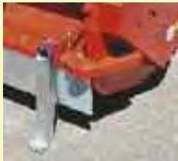
Abweiser am Gehäuse verhindern ein Hängenbleiben an Reben, Hagelnetzen oder anderen Hindernissen. Die groß dimensionierten Stützfüße ermöglichen ein komfortables Abstellen der Maschine.
