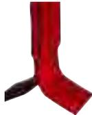
Die paarweise aufgehängten Klingen sind leichtgängig, langlebig und erfordern nur einen geringen Kraftbedarf. Darüber hinaus sorgen sie für eine gute Verteilung der Mulchmasse. Klingensmesser lassen sich beidseitig verwenden und sind sehr beliebt, weil sie bei der Arbeit wenig Staub entwickeln.
