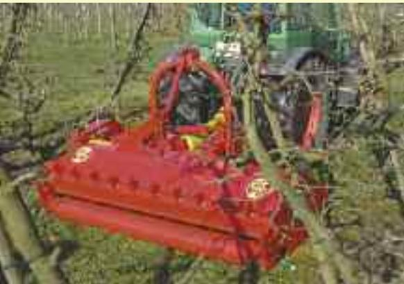
KM mit Aufnahme- und Zerreibvorrichtung zum Holz zerkleinern.
