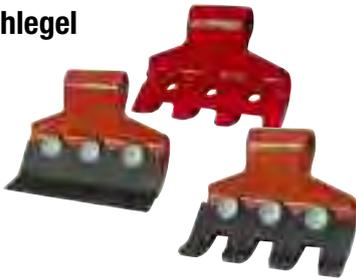
Der Systemshlegel entwickelt aufgrund seiner besonderen Form und dem hohen Eigengewicht von 2,7 kg eine vorteilhafte Saugwirkung und ein besonders schönes Schnittbild. In das Tiefbett des Messerträgers wird wahlweise eine Feinschnittklinge oder eine Krallenklinge eingeschraubt. Die Klingen können kostengünstig ausgewechselt werden.
