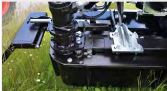
GREENTEC Schlegelmulchköpfe können auch mit einem hydraulisch angetriebenem Wurfförderband ausgestattet werden. Das gemulchte Material wird aus der Arbeitsspur aufgenommen und seitlich abgelegt. Diese Sonderlösung eignet sich ideal für Böschungen und Gräben in Wassernähe, um die Wasserläufe frei zu halten.
