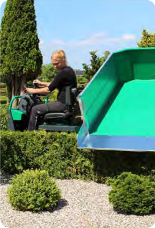
Hydraulische Kipppritsche und 180° schwenkbar
