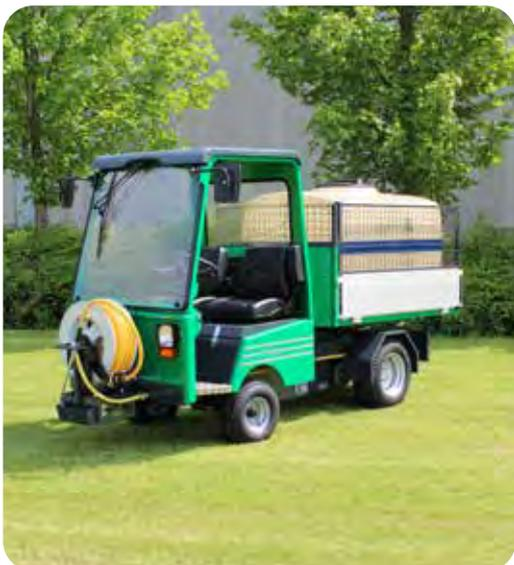
Mit aufgebauter Giessanlage und elektrischer Unterflurpumpe
