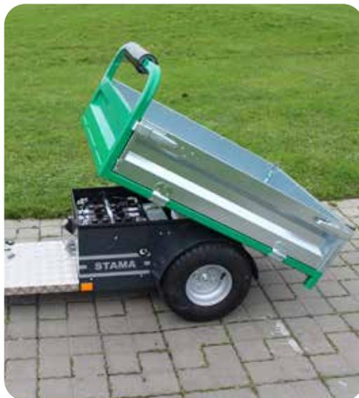
Kipper zum Entladen und Zugang zur Batterie
