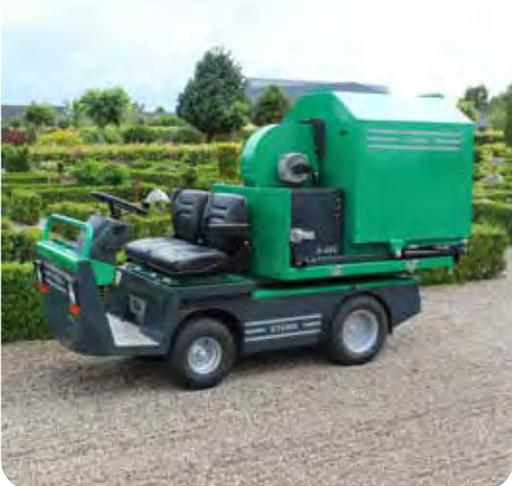
Ausführung mit vollelektrischer Saugeinheit
