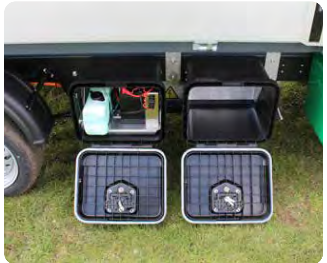
Linke Box: Wassertank für Wisch/Wasch-Anlage und 12 Volt Batterie für Verbraucher Rechte Box: Werkzeugbox (Optional)
