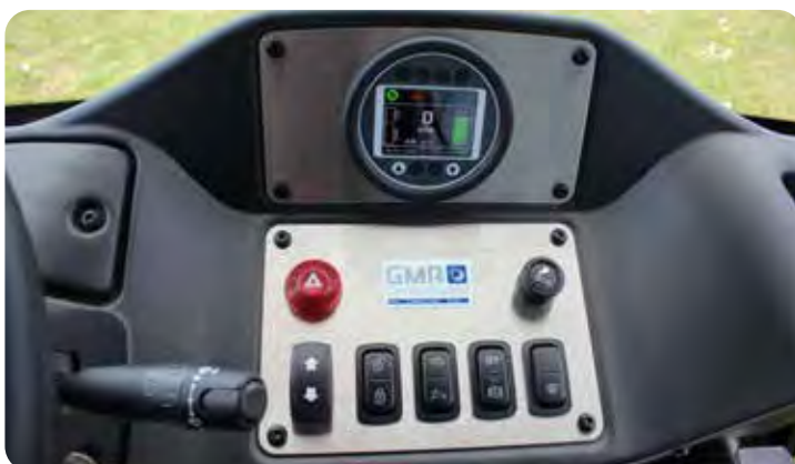
Armaturenbrett mit Bedienfelder-Vorwärts-Rückwärts- schalter, Warnlichtschalter, Schalter zum Verriegeln-u. Entsperren der Türen, 2-Stufen-Fahrschalter Schnell/ Langsam, Berganfahrassistent, Scheibenwischer Ein/ Ausschalten, Wischwasser, Zigarettenanzünder
