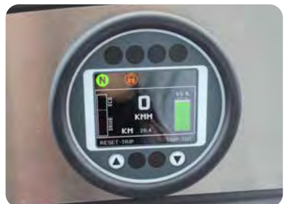
Kontrolldisplay mit Kilometeranzeige, Betriebsstundenzähler Batterieladeanzeige, Fehlercodes
