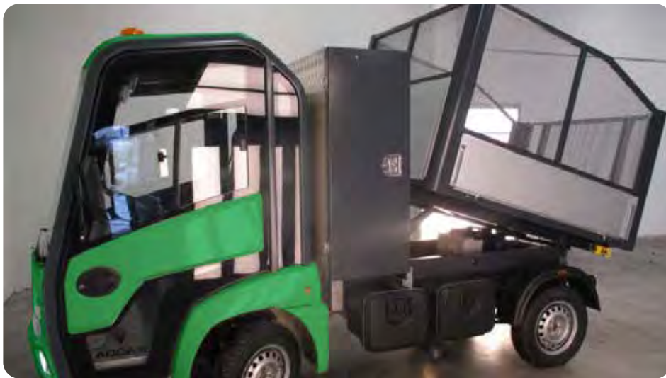
Kurzem Heckkipper mit seitlich abklappbaren Bordwänden und Werkzeugbox
