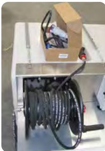
Hochdruckreiniger, 130 bar, 210 Liter mit Lithium-Batterien
