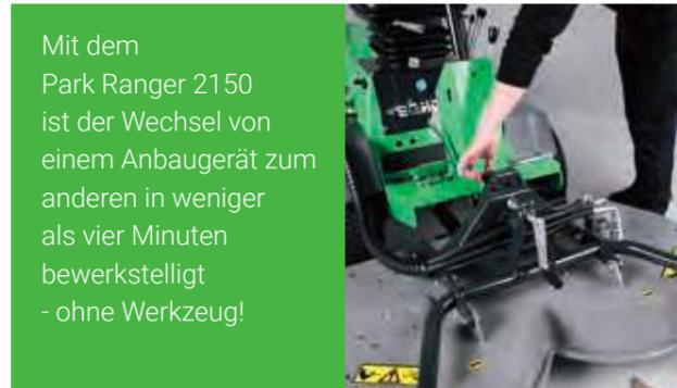
Mit dem Park Ranger 2150 ist der Wechsel von einem Anbaugerät zum anderen in weniger als vier Minuten bewerkstelligt - ohne Werkzeug!
