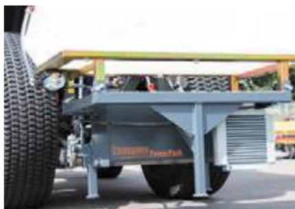
bema PowerPack mit Ölkühler und Wassertank im Heck
