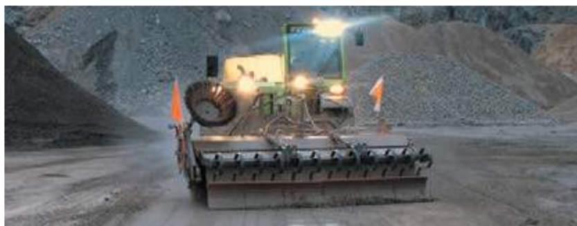
bema 75 Dual PowerMaster mit Aufkratzvorrichtung anstatt Schmutzsammelwanne, Seitenkehrbesen, Hochdruckspülanlage und Wassertank im Heck (siehe Seite 58/59)
