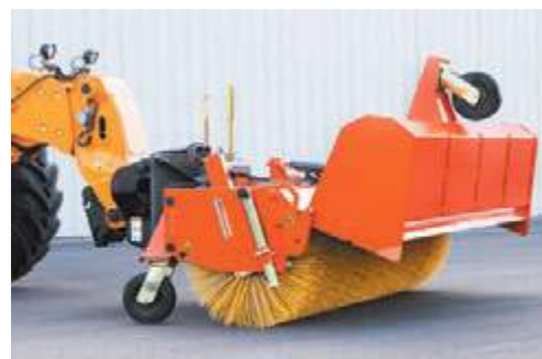
bema 30 Dual PowerMaster am Radlader, Schmutzsammelwanne Dual geöffnet
