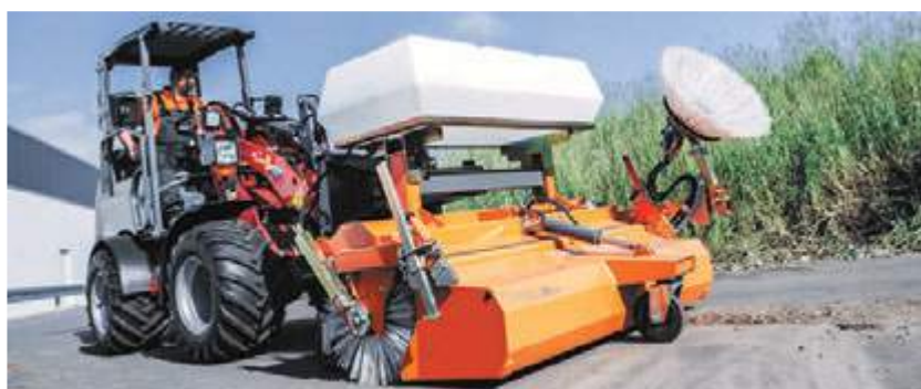
bema 20 Dual mit Wassersprüheinrichtung und Seitenkehrbesen
