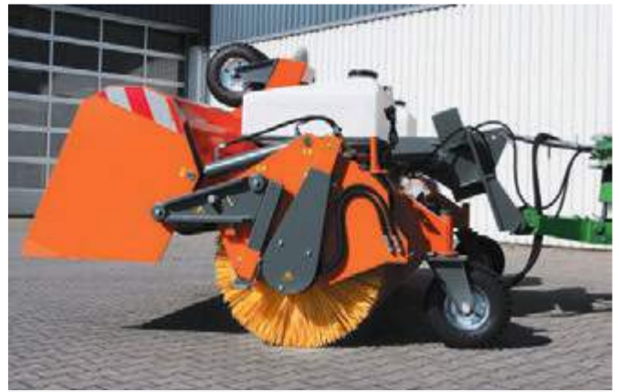
Schmutzsammelwanne geöffnet (Freikehren)
