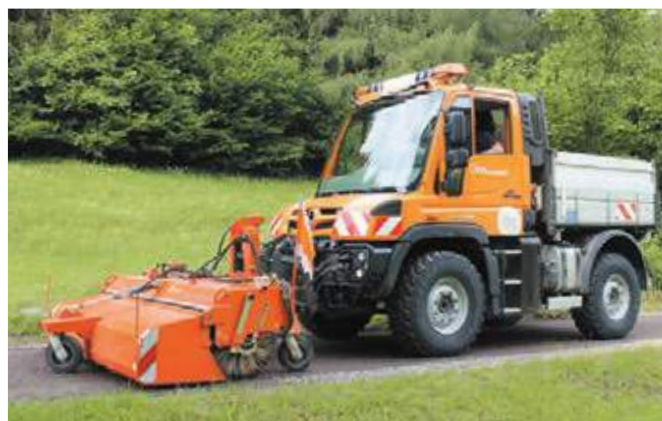
bema 35 Dual PowerMaster im kommunalen Einsatz, Unimog-Anbau
