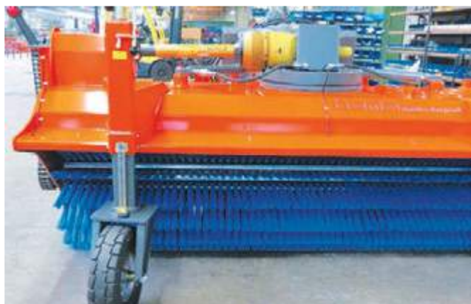
bema Jumbo Airport - stufenlos höhenverstellbare Laufräder
