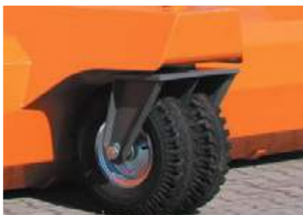
Stabile Zwillingslaufräder mit verstärkten Felgen (Super-Elastik-Vollgummiräder Ø 446 x 122 mm)
