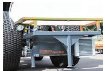
bema PowerPack mit Ölkühler und Wassertank im Heck
