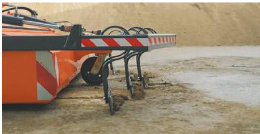
Aufkratzschiene unterteilt in Hardoxsegmente
