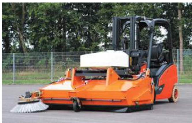
bema 40 Industry mit Seitenkehrbesen und Wassersprüheinrichtung
