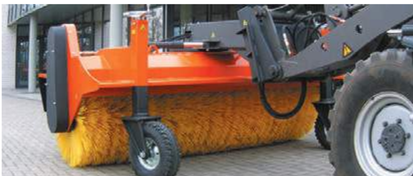
bema Jumbo am Radlader (Schnellwechselanbau mit Rollenniveaueausgleich)
