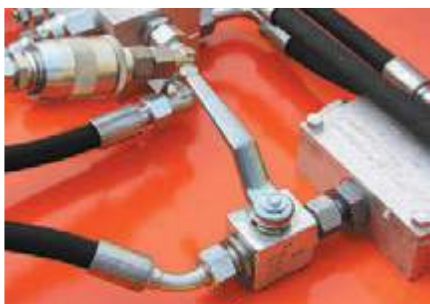
Schwenkdrossel & Mengenteiler (gleichmäßiges Anheben des Schneeschildes)
