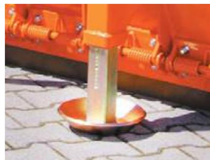
Variante 2: Federklappen & Gleitkufen
