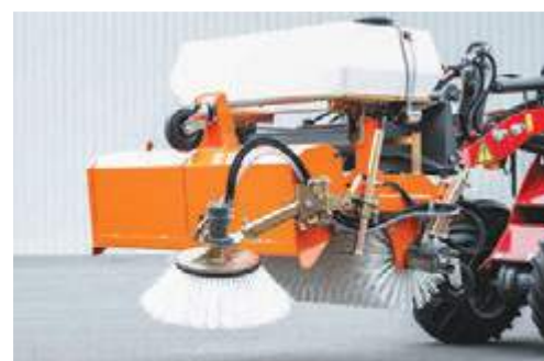
bema 20 Dual in Volllausstattung, Schmutzsammelwanne im bewährten Dual System
