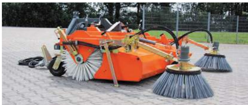
bema 25 Dual mit zwei Seitenkehrbesen - Wildkrautbesatz
