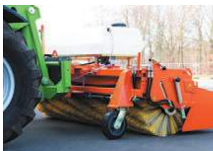
Stabile Super-Elastiklaufräder Ø 300 x 90 mm, Anbau Teleskopklader
