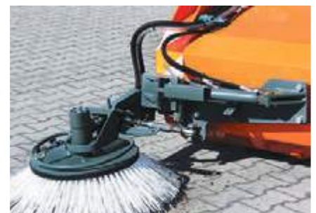
Stabiler Anbau der Seitenkehrbesen
