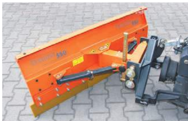
bema Schneeschild Serie 550, mechanische Winkeleinstellung
