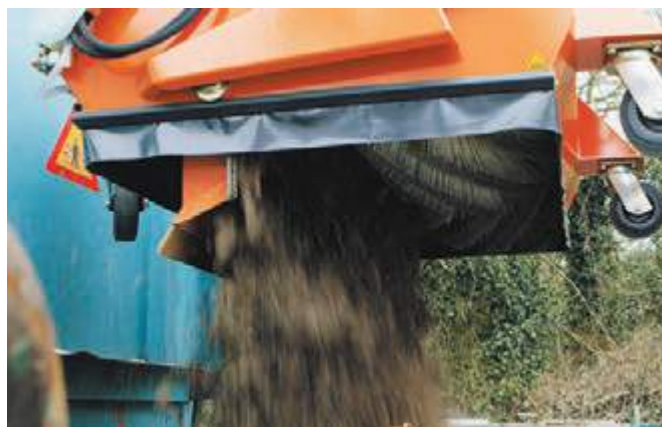
Komfortable Hochentleerung über Container
