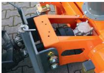
Antrieb der bema Saug-Kehrdüse über Frontzapfwelle (optional erhältlich)
