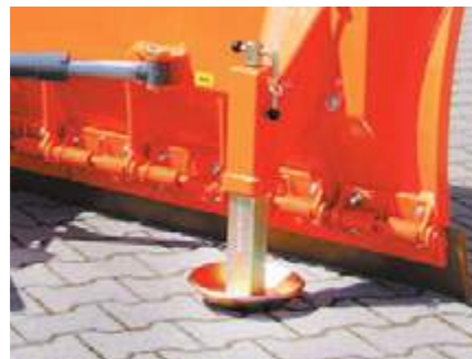
Variante 2: Federklappen & Gleitkufen
