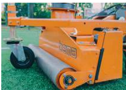
Störungsfreier Einzug durch die pendelnde Niederhalterwalze
