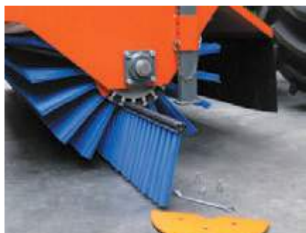
Kassettsystem mit Bürstenelementen
