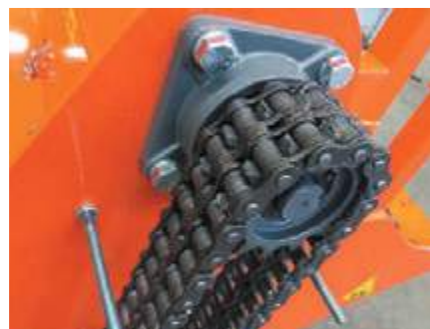
Mechanischer Antrieb über Duplex-Kette
