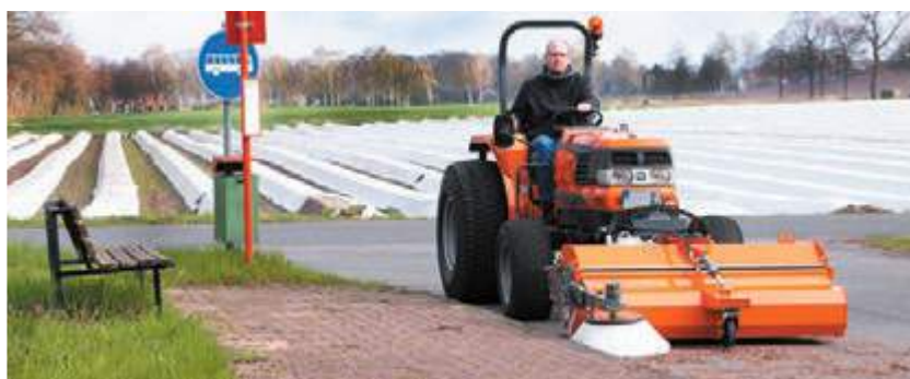
bema Kommunal 580 Dual mit Seitenkehrbesen - optimal für Bordsteine, Rinnsteine und an Gebäuden
