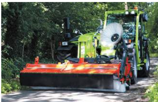
bema 30 Dual PowerMaster ohne Schmutzsammelwanne (Freikehren)
