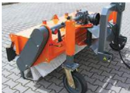
Ausführung mit Getriebe und noch stabileren Laufrollen Ø 360 x 85 mm (Sonderbau)
