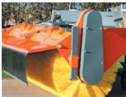
Kettenkasten (seitlicher Kettenantrieb)
