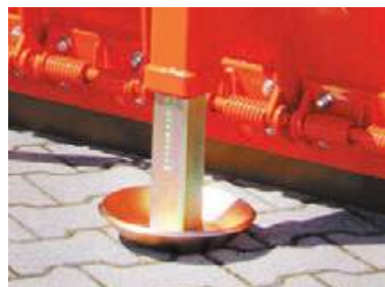
Variante 2: Federklappen & Gleitkufen
