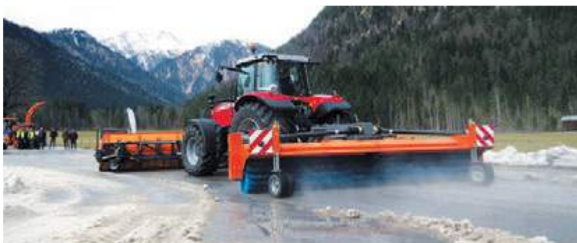
bema Jumbo Airport Turbo überzeugt mit 5200 mm Arbeitsbreite
