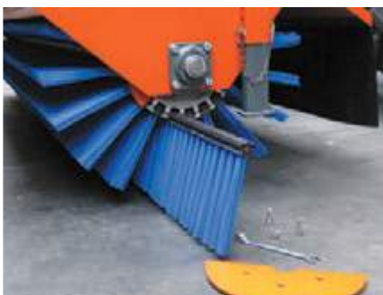
Kassettensystem mit Bürstenelementen
