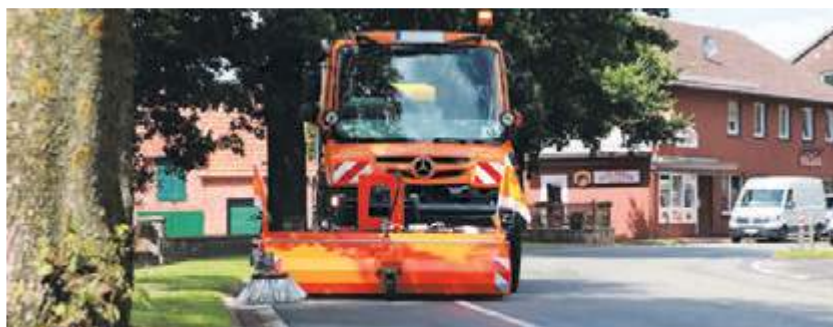
bema 30 Dual PowerMaster am Unimog mit Seitenkehrbesen und hydraulische Seitenverschiebung (rechts/links je 500 mm)
