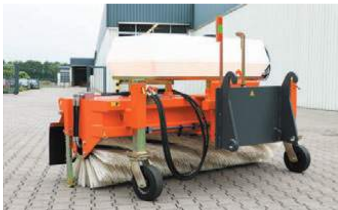
bema 3 Robust mit Wassersprüheinrichtung
