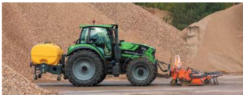
bema 35 Dual PowerMaster ausgestattet mit Schmutzsammelwanne Dual inkl. Aufkratzvorrichtung, Hochdruckspülanlage, Wassertank im Heck und zertifiziertem Kamerasystem (siehe Seite 58/59)
