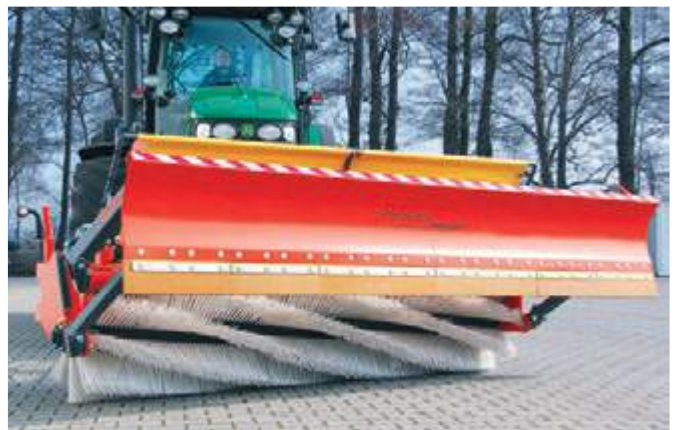
bema Snow-Combi mit hochgeklappten Schneeschild - Freikehren
