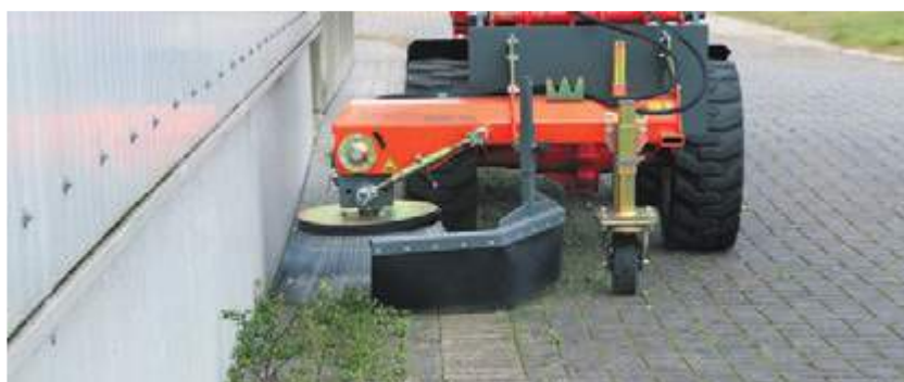
bema Groby light, Stützrad Ø 200 x 80 mm (höhenverstellbar)
