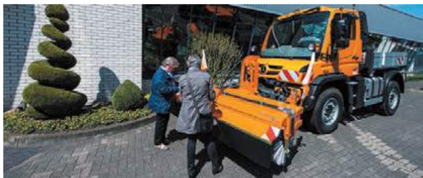
bema 3 Robust - Anbau Unimog-LKW mit hydraulischer Seitenverschiebung
