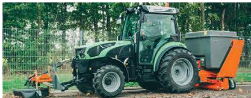
Komplette Heckeinheit in Kombination mit bema Groby light in Front (Effektive Wildkrautbeseitigung, siehe Seite 40/41)
