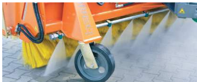
Hochdruckspülanlage - je nach Maschinenbreite bis zu 11 Hochdruckdüsen
