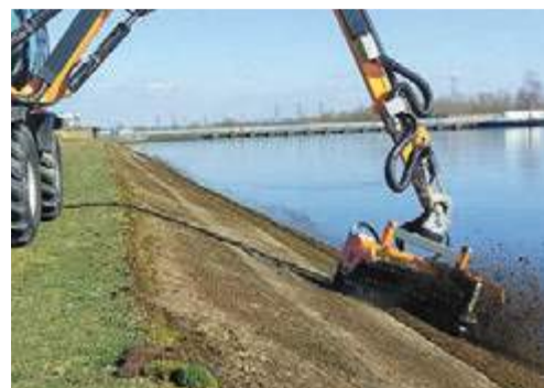
bema 25 mit Wildkrautbürste, Anbau Bagger (Sonderbau)
