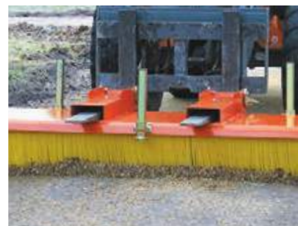
Paletttaufnahme mit werkzeugloser Arretierung
