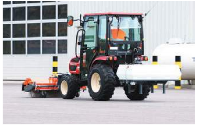
bema Kommunal 450 Dual mit Wassertank im Heck
