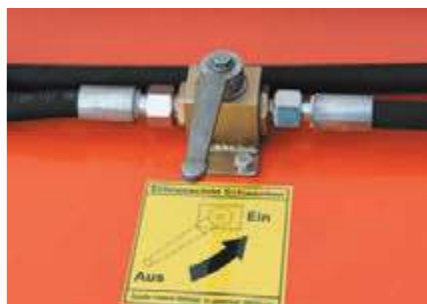
Absperrhahn zum Verriegeln des hochgeklappten Schneeschildes
