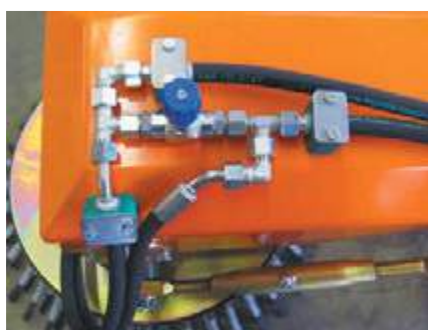
Drehzahlregulierung des Tellerbesens
