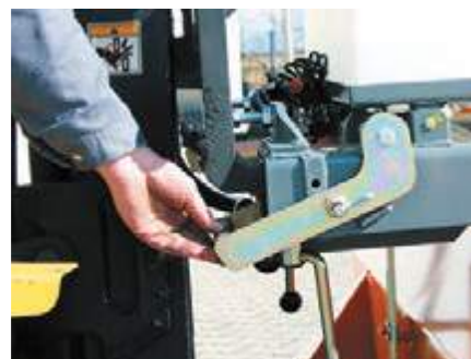
Verriegelung der Aufnahme am Gabelstapler
