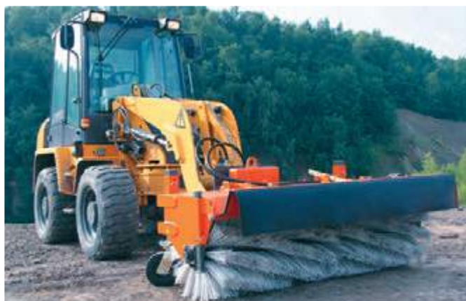
bema 3 Robust - Radladeranbau mit Spritzschutz
