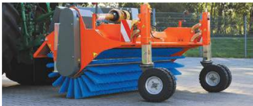
bema Jumbo Airport im Schlepper-Heck, Sonderbau mit hydraulischer Stützradverstellung
