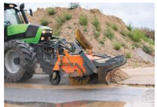
bema Aufkratzvorrichtung ohne Schmutzsammelwanne
