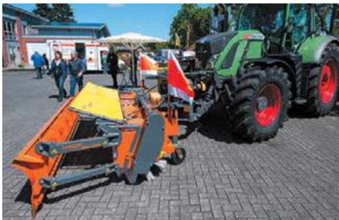
bema Snow-Combi am Schlepper mit optionalem Schneestaubschutz
