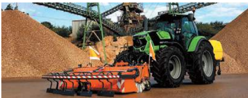
bema Aufkratzvorrichtung mit Schmutzsammelwanne in Kombination mit bema Hochdrucksprünanlage und Wassertank (2000 Liter) im Heck
