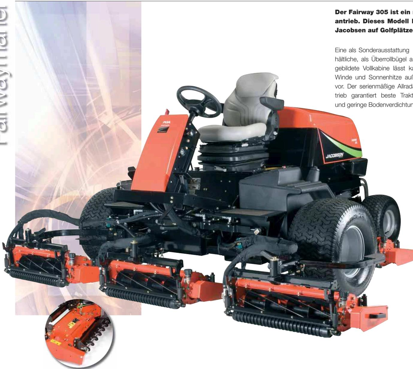
Verstellbare Auswurfichtung nach vorn oder hinten erlaubt den schnellen Wechsel von Schnittgutaufnahme zu Heckauswurf (im Bild auch rotierende Rollenbürste als Sonderausstattung)
