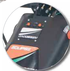
Serienmäßige LCD-Anzeige und Eingabetasten ermöglichen einfache Einstellung von Schneid- zylinderdrehzahl und Arbeitsgeschwindigkeit
